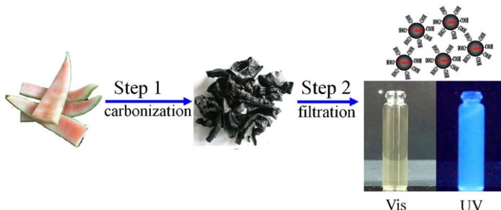
**Figura 9: sintesi di CDs fluorescenti e solubili in acqua a partire da un materiale organico di scarto (buccia di anguria) mediante metodo di pirolisi [26]**
