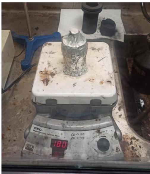
*Figura 14: autoclave su piastra riscaldante REC Digital Heating Ceramic Plate di VELP Scientifica sotto cappa a filtrazione molecolare versione standard modello GS1200 di Savatec*
