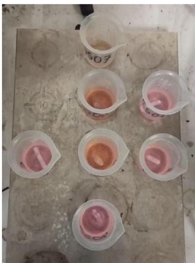
**Figura 23: campioni di soluzione di colorante rosso con CDs posizionati sulla piastra magnetica di VELP Scientifica per 24 ore prima di effettuare le analisi mediante spettrometro UV-Vis**
