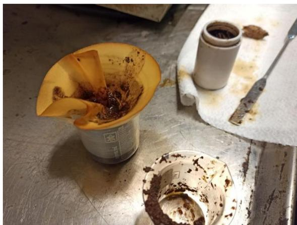
***Figura 15: filtraggio della soluzione decantata tramite filtro di Whatman dal diametro di 90 mm piegato a forma di cono e appoggiato su un piccolo becher***
