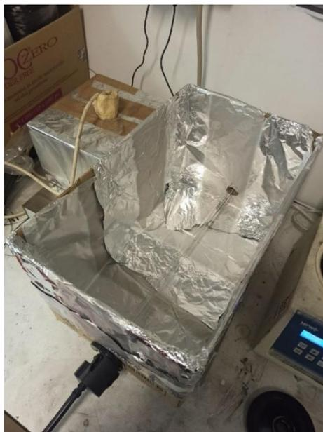
***Figura 22: set-up sperimentale con Lampada VIQUA S463RL: in foto si vede l'interno della scatola rivestita di carta stagnola con la lampada inserita in verticale attraverso due fori. Durante la fase di irraggiamento UV con la lampada accesa, questa scatola viene posta sopra i campioni posizionati sullo stirrer magnetico di VELP Scientifica.***
