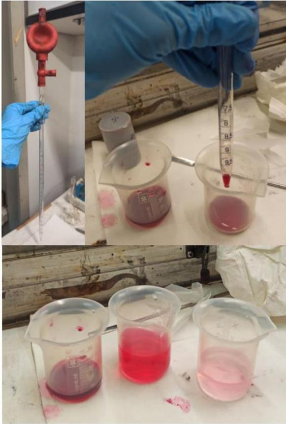
*Figura 21: in alto a sinistra una foto della pipetta graduata da 10 mL con pompetta di gomma a tre valvole; in alto a destra e in basso due foto degli step di prelievo e diluizione per arrivare alla concentrazione finale di 10 mg/L della soluzione di acqua distillata e colorante rosso estratto di cocciniglia*
