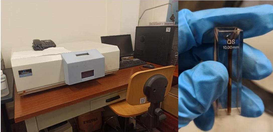
*Figura 19: spettrometro per la fluorescenza LS 55 si Perkin Elmer e cuvetta al quarzo per le analisi al fluorimetro*
