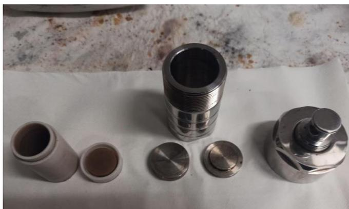
*Figura 13: da sinistra il contenitore in teflon, il corpo metallico con le due basi e parte superiore*
