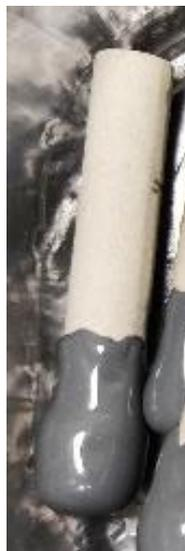
*Figura 30 Capsula con estremità impermeabilizzata con stucco e Plastigel.*
