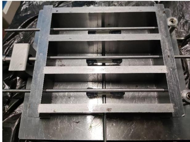
*Figura 35 Cassaforma per 3 provini con capsule posizionate nelle cavità.*
