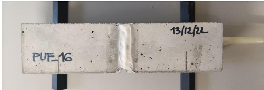
Figura 56 Fase preparativa provini: siliconatura facce laterali della fessura.
