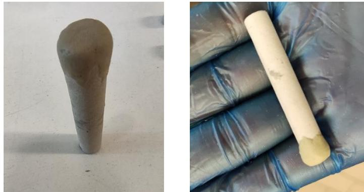
*Figura 29 Capsula con una estremità sigillata con stucco epossidico.*
