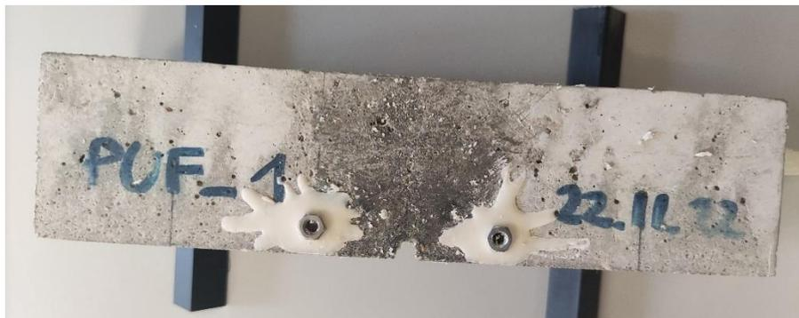
*Figura 60 Fissaggio dadi sulla faccia laterale del provino.*
