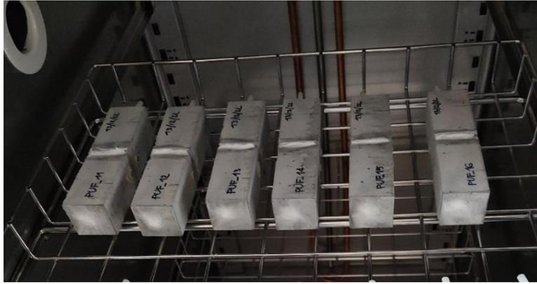
*Figura 65* Trattamento stagionatura PUF in armadio termico.
