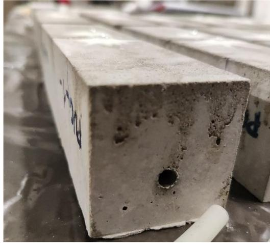
*Figura 40 Provino dopo rimozione dalla cassaforma.*
