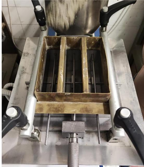
*Figura 38 Posizionamento della cassaforma sulla macchina compattatrice.*
