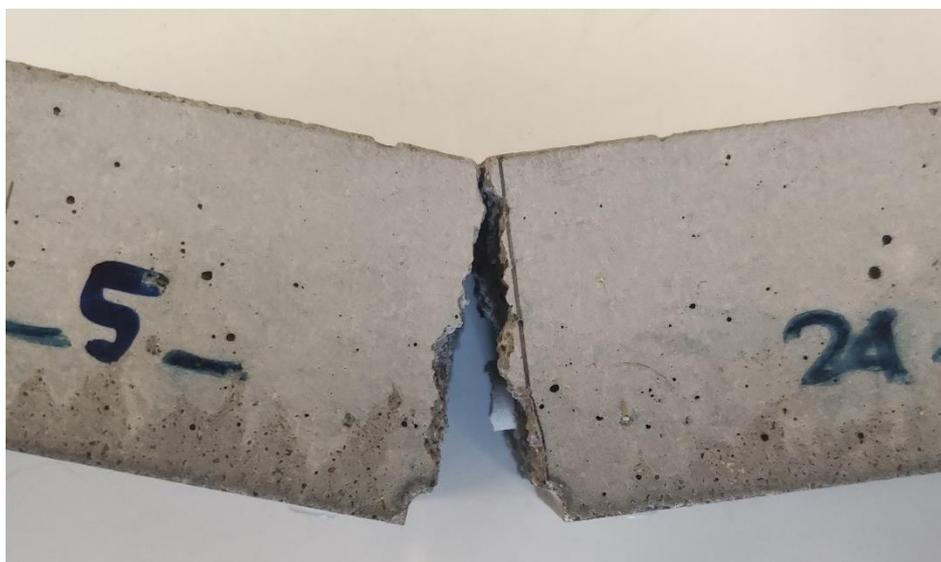
*Figura 77 Dettaglio provino PUC\_5 post rottura.*
