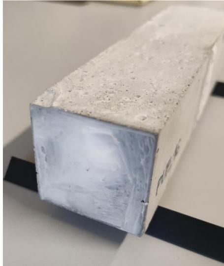
*Figura 42 Seconda estremità provino sigillata con silicone.*
