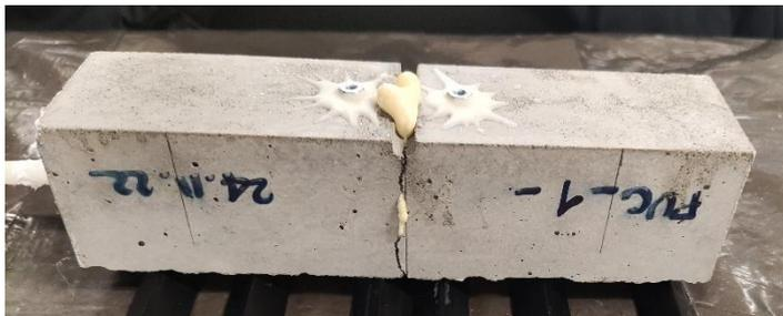
Figura 69 PUC\_1 riassemblato dopo pre-fessurazione.
