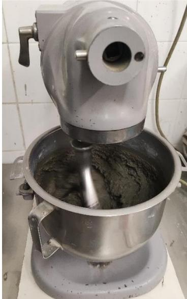
*Figura 37 Fase di miscelazione in macchina.*
