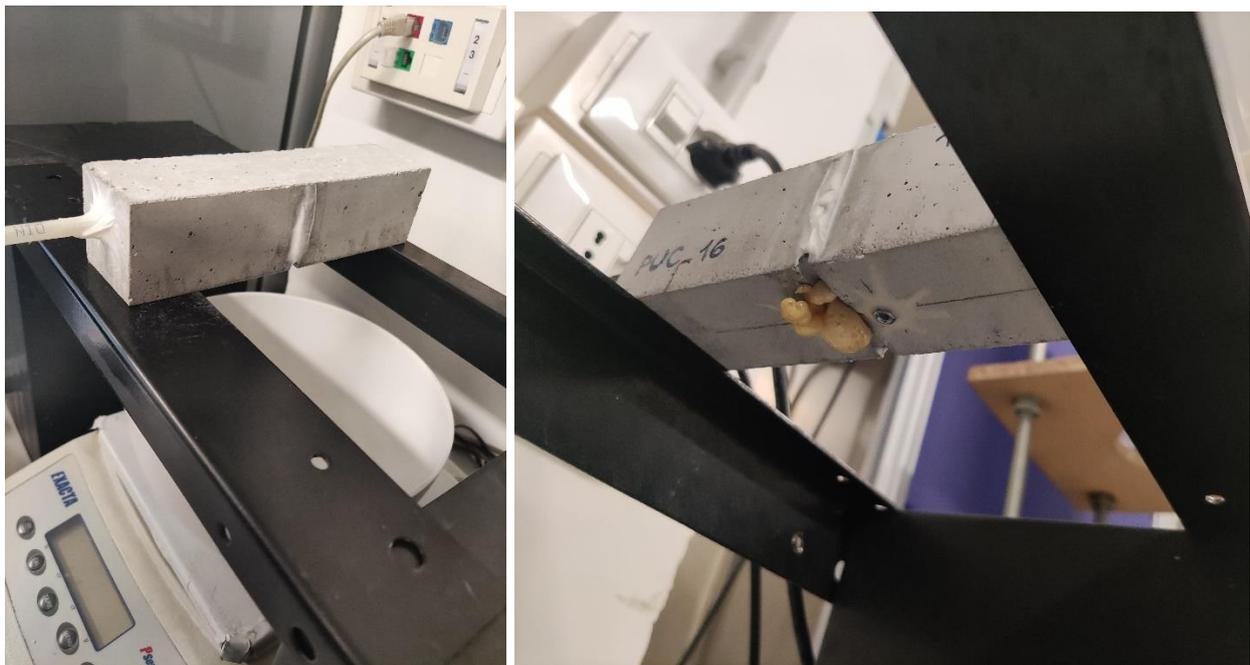
Figura 54 Posizionamento provino su supporti.
