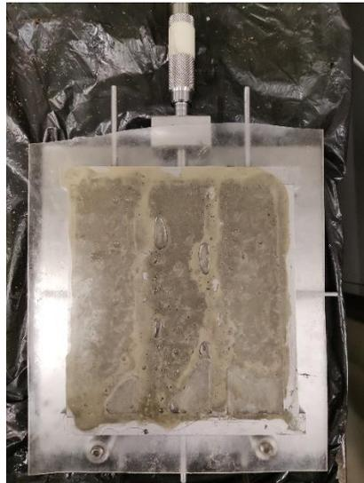
*Figura 39 Fine della fase di getto e copertura della cassaforma.*
