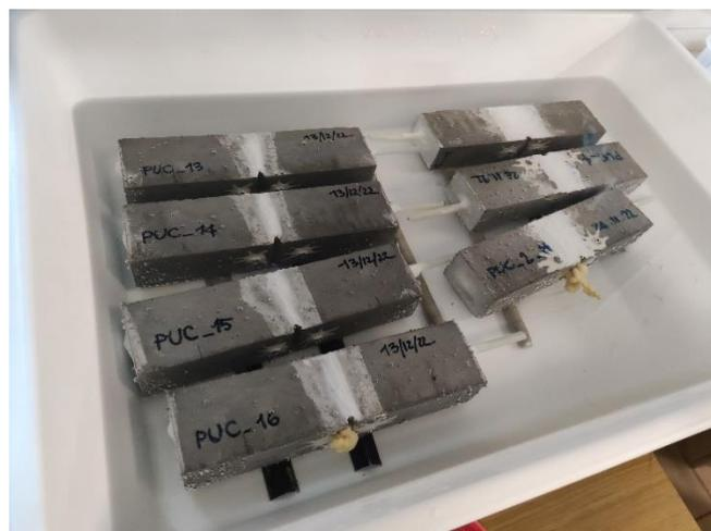
Figura 57 Fase preparativa dei provini: saturazione in acqua distillata.
