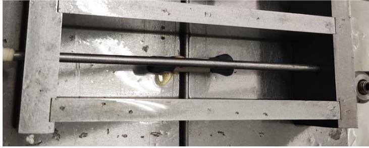
Figura 99 Dettaglio capsula PUF\_9 durante il getto.
