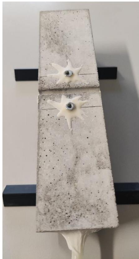
Figura 44 Fase di incollaggio dadi sulla faccia inferiore.
