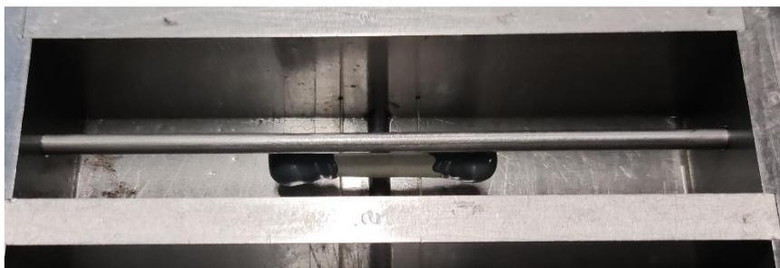
*Figura 36 Dettaglio posizionamento capsula nella cavità.*
