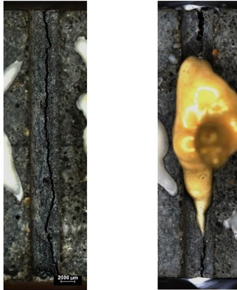
Figura 52 Immagine di fessure (REF\_1 a sinistra e PUC\_1 a destra).
