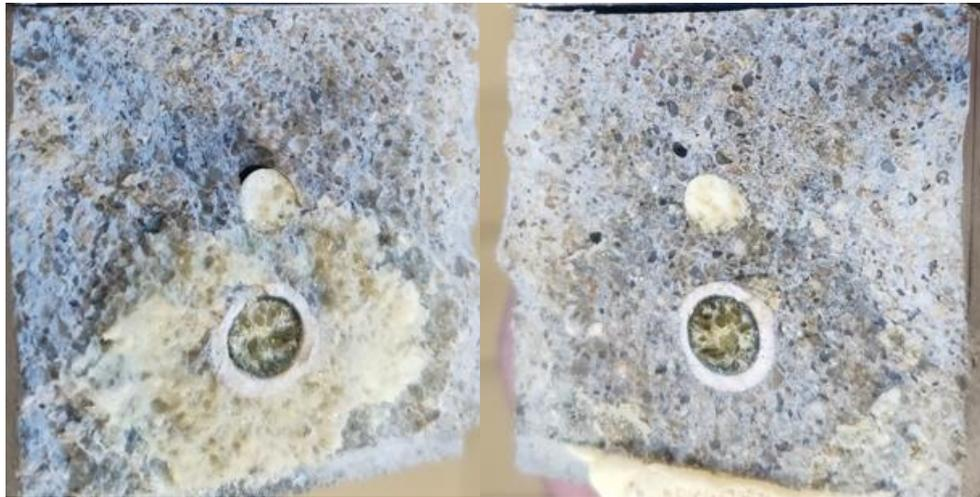
*Figura 97 Superfici di frattura PUC\_3.*
