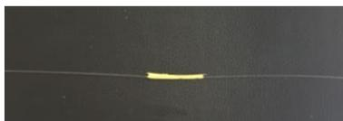
**Figura 9.1.** Rivestimento della zona di giunzione tra fibra ottica e terminale.
