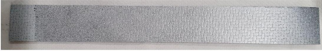
**Figura 8.16.** Pattern di puntini realizzato sul provino.
