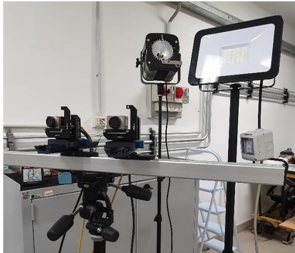
**Figura 8.17.** Dettaglio delle camere e delle luci rivolte verso il provino.
