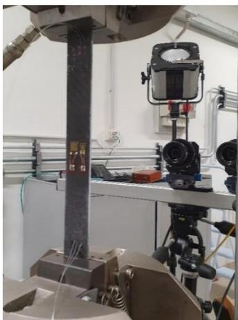
**Figura 9.2.** Campione sottoposto al rilevamento della deformazione durante una prova di trazione mediante fibre ottiche, estensimetri e DIC.
