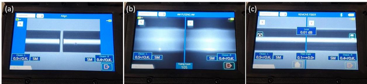
Figura 8.14. Immagini prese dalla microcamera della splicer durante il processo di fusione. (a) allineamento delle fibre; (b) fusione; (c) indicazione della perdita al termine della fusione.
