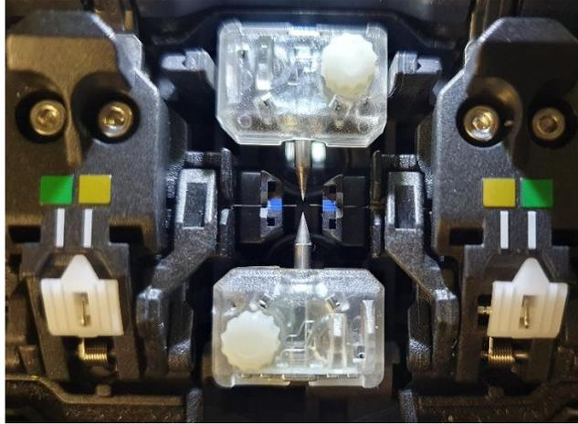
Figura 8.13. Disposizione delle fibre nella splicer prima della fusione.
