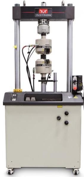
**Figura 8.22.** Instron 8801 utilizzata per le prove di trazione [55].
