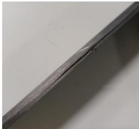
**Figura 8.5.** Un'inclusione all'interno di questo provino ha provocato delaminazione durante il taglio.
