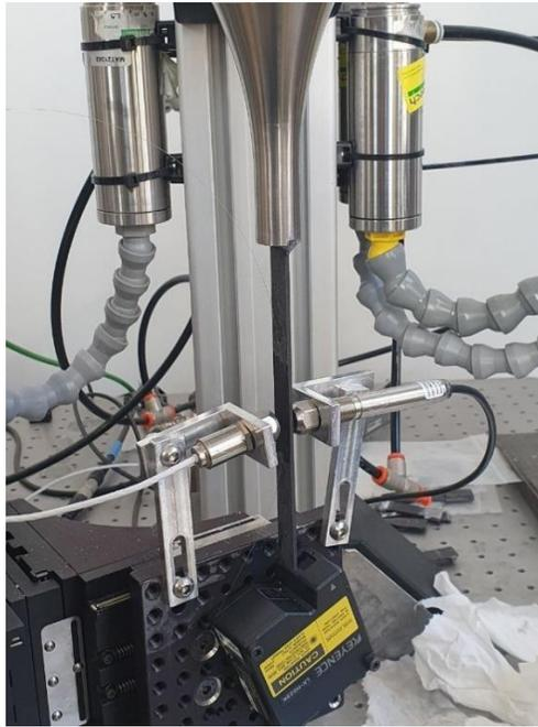
**Figura 8.24.** Posizionamento del campione per prove VHCF.
