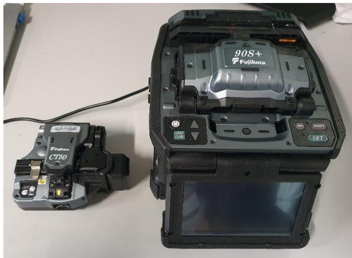
**Figura 8.12.** Strumentazione per lo splicing: a sinistra la taglierina (*cleaver*) e a destra la splicer vera e propria.
