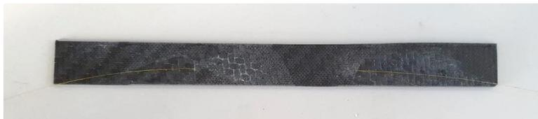
**Figura 8.23.** Campione utilizzato per le prove VHCF.
