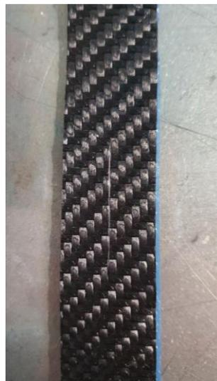
**Figura 8.2.** Dettaglio di una fibra ottica infilata tra i layer di prepreg. Sulla superficie visibile verranno adagiati i due strati rimanenti.
