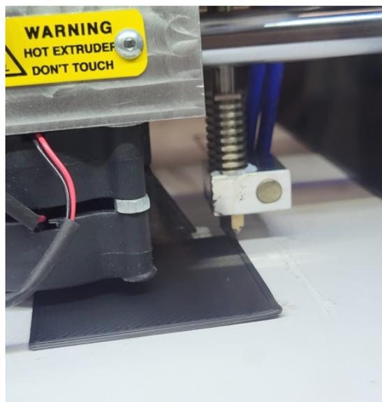
Figura 73. Stampaggio provino in Grafylon®3d con parametri ottimizzati.
