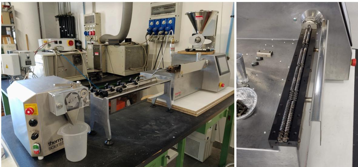
Figura 30 – A sinistra: estrusore Process 11, vasca dell'acqua e taglierina; a destra: viti all'interno del cilindro. [29]
