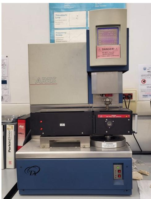
Figura 45. Reometro Ares della TA Instruments.
