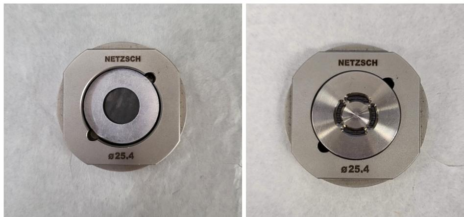
Figura 54. Porta campioni per analisi *cross-plane* (a sx) e *in-plane* (a dx).
