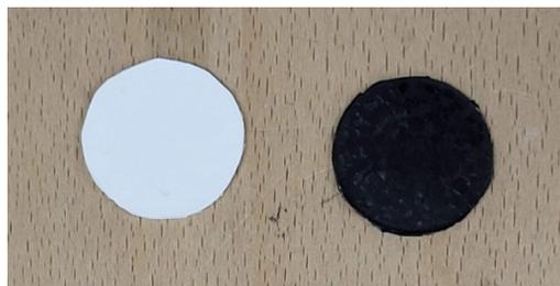
*Figura 61. Provini per analisi al light flash.*
