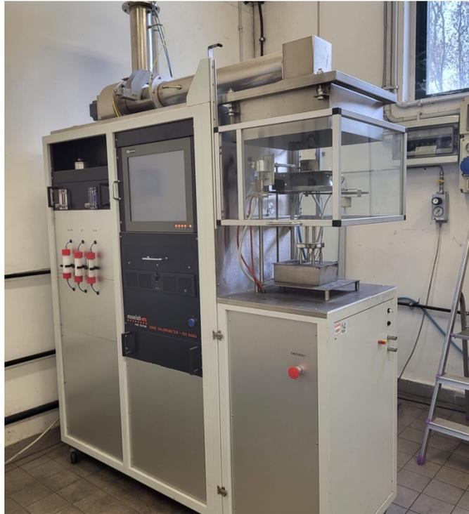
Figura 51. Cono calorimetrico.
