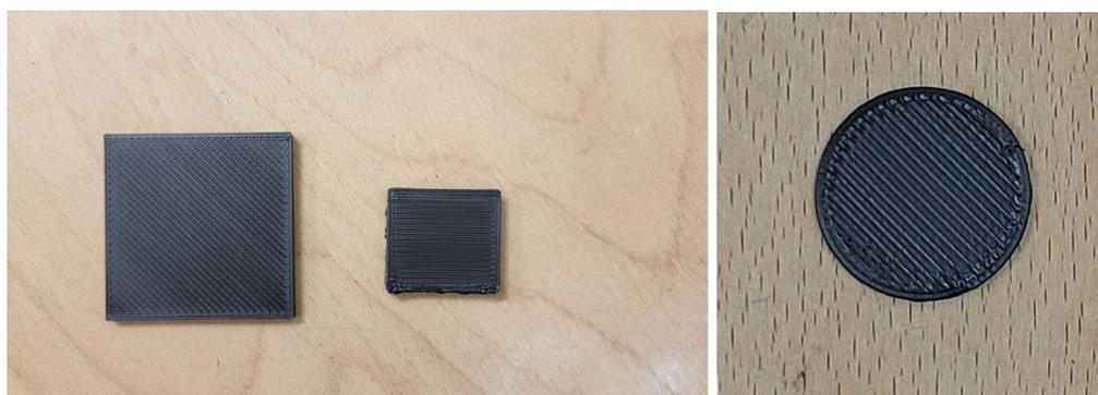
Figura 74. Provini in Grafylon®3d. A partire da sinistra: provino per hot disk con pattern ±45, provino per hot disk con pattern 0-90, provino per light flash.
