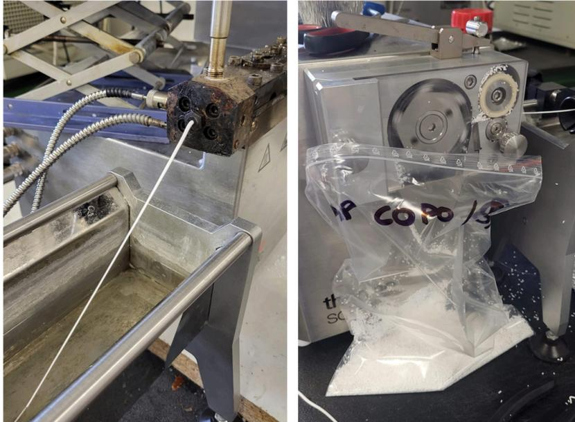
Figura 58. A sx: composito polimero all'uscita dell'estrusore; a dx: pellettizzazione del materiale estruso.
