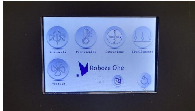
Figura 41 - Pannello di controllo della stampante Roboze One. [31]
