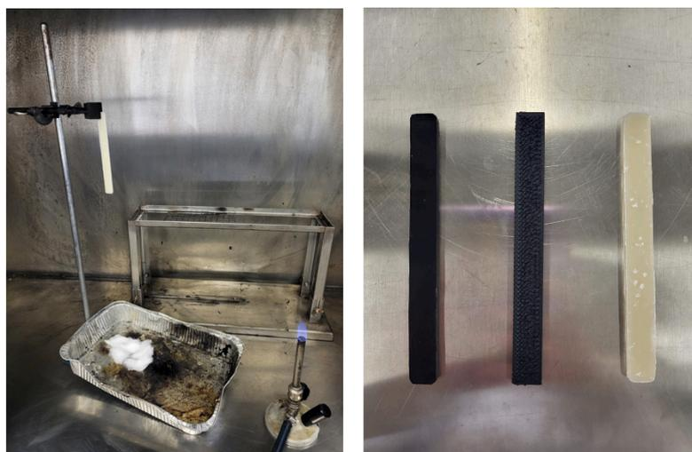
Figura 49. A sx: apparato sperimentale. A dx: provini per il test UL94.
