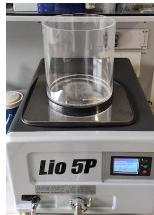
**Figura 3.10.** Liofilizzatore LIO 5PDGT della Savotec.
