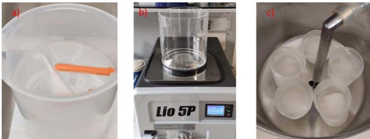
**Figura 3.14.** a) dialisi del chitosano inserito in fogli di cellulosa immersi in acqua distillata; b) liofilizzatore utilizzato per la rimozione dell'acqua; c) chitosano metacrilato inserito nella camera del liofilizzatore.
