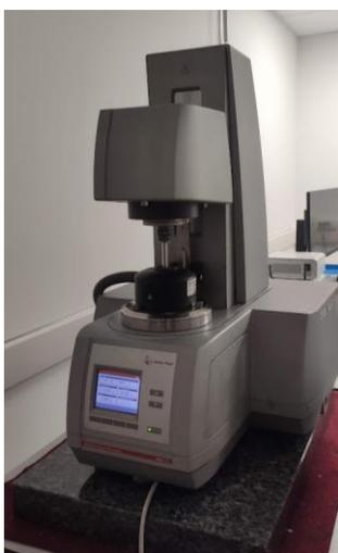
**Figura 3.4.** Fotoreometro della Anton PAAR.
