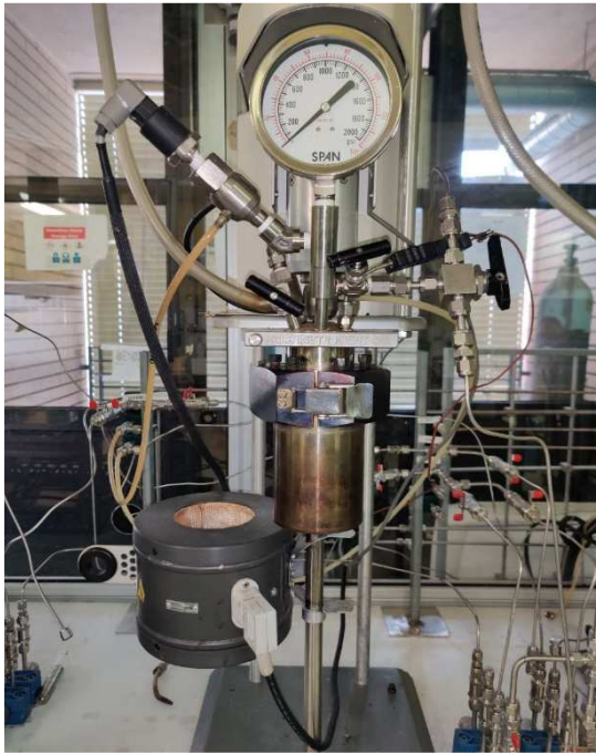
Figura 22: Sinistra: Reattore Parr senza camicia di riscaldamento. Destra: Reattore Parr con camicia di riscaldamento.
