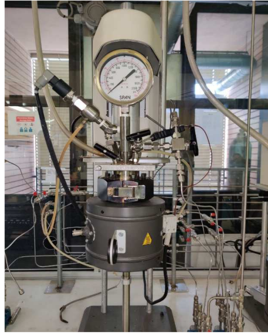
Figura 22: Sinistra: Reattore Parr senza camicia di riscaldamento. Destra: Reattore Parr con camicia di riscaldamento.
