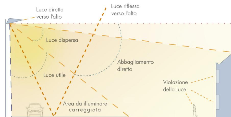
**FIG 14:** Schematizzazione della propagazione della luce elettrica, elaborazione personale a partire dai dati forniti dalla: Legge regionale 9 febbraio 2018, n. 3. Modifiche alla legge regionale 24 marzo 2000, n. 31 (Disposizioni per la prevenzione e lotta all'inquinamento luminoso e per il corretto impiego delle risorse energetiche)
