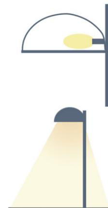
**FIGURA 14:** Tipologia di apparecchio full cut-off, rielaborazione personale sulla base dei dati forniti da "Apparecchi totalmente schermati (apparecchi full cut-off)" all'interno di "Inquinamento luminoso e protezione del cielo notturno" Cinzano P., 1998
