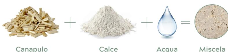
Figura 2.09 - Schema di rappresentazione dei costituenti della miscela
