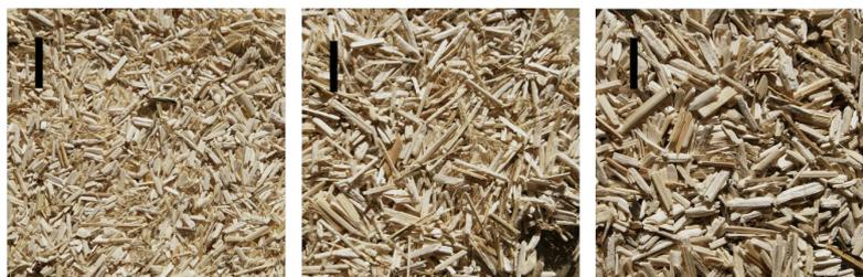
Figura 2.06 - Raffigurazione delle pezzature del canapulo. Da sinistra 3,5 mm, 10 mm e 22 mm
