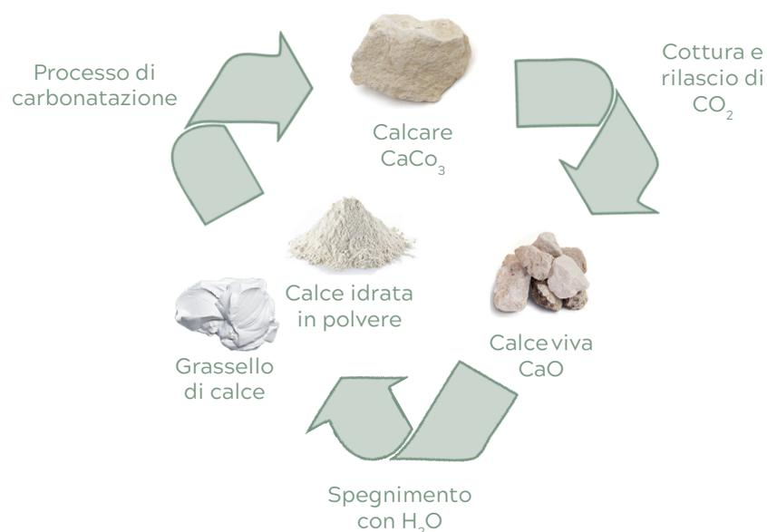
Figura 2.08 - Sintesi del processo di produzione del grassello di calce e della calce idrata in polvere.
