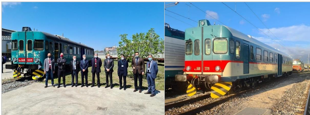
**Figura 8:** ALn 668 serie 3000 (n° 3319), convertita da diesel (a sx) a BioLNG (a dx) dalla Fondazione FS (anni di costruzione: 1982-1983), 2021. Fonte: Fondazione FS.
