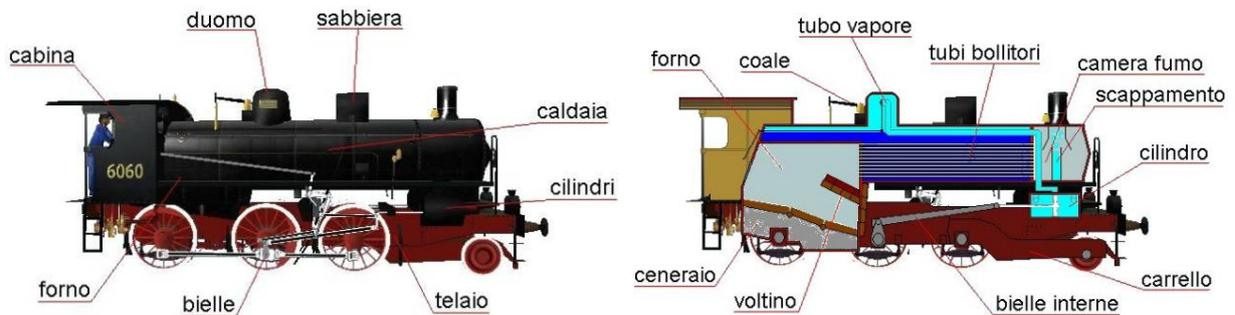
Figura 7: Componenti di una locomotiva a vapore. Fonte: Ferrovie dello Stato.
