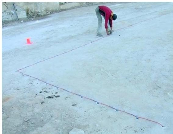
La sistemazione della miccia detonante all'interno dei fori precedentemente praticati
