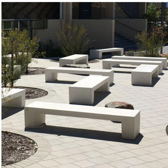
Sarah è una collezione di panchine a ponte, costruite in PDM (Pietre Ricostituite). Il PDM è una miscela con buone performance tecnico-strutturali, realizzata in composto legante e inerti di granito o marmo, accuratamente lavati e selezionati. Le superfici di pietra ricostituita sono trattate con apposite vernici antidegrado trasparenti satinata, che ne aumentano la durata nel tempo.
