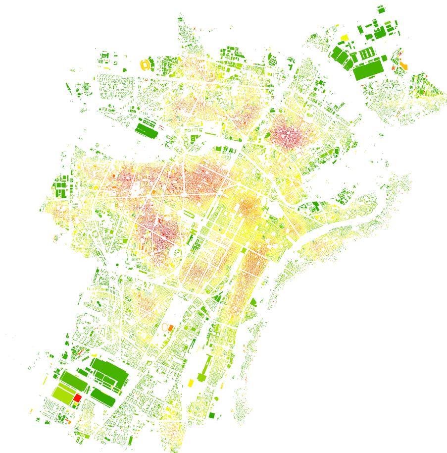
Figura 2.14: Rappresentazione grafica dell'indice di straightness per ogni edificio del campione
