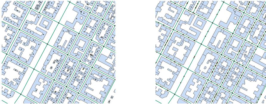
Figura 2.2: A sinistra sono stati aggiunti i centroidi che nell'immagine a destra sono poi stati proiettati lungo la rete stradale per formare nuovi nodi nella rete complessiva.
