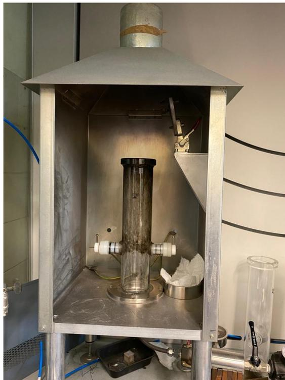
**Figura 38** Tubo di Hartmann utilizzato in laboratorio
