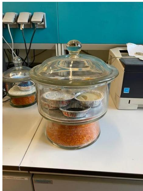
**Figura 37** Essiccatore a gel di silice utilizzato in laboratorio
