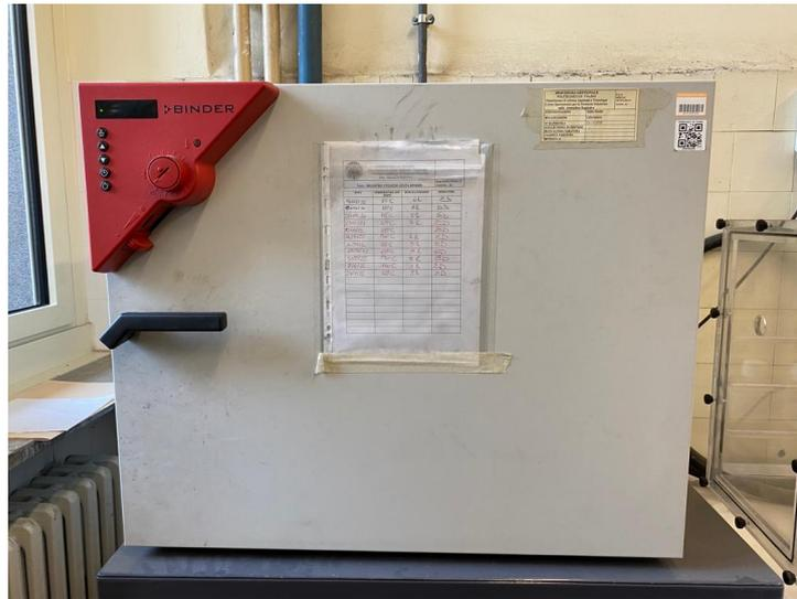
**Figura 36** Stufa termostatica da laboratorio
