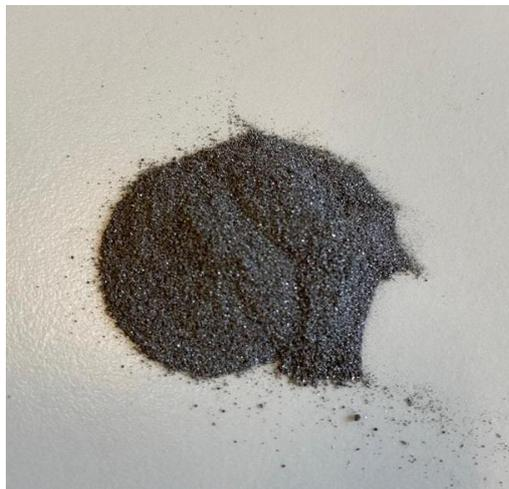
**Figura 32** Immagine della polvere 'da fresa'
