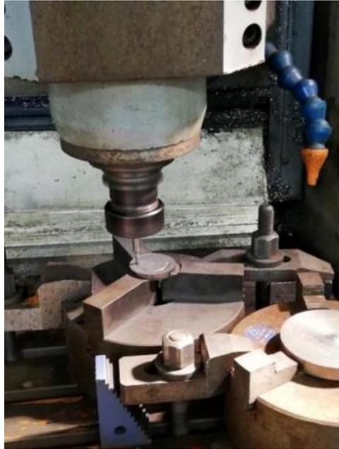
**Figura 31** Esempio di macchina da fresa per l'ottenimento di un toroide da un disco originario
