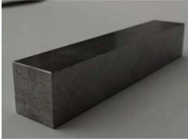
**Figura 14** Immagine di un provino SMC dopo pressatura, tratto da [17]
