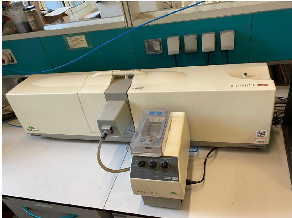
**Figura 35** Granulometro laser Malvern Mastersizer 2000M utilizzato in laboratorio
