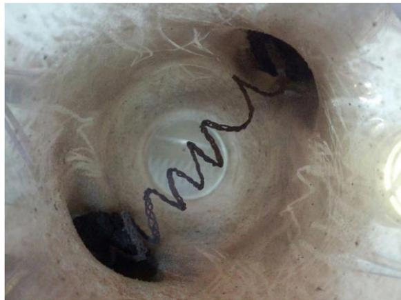
**Figura 39** Filo in Costantana inserito all'interno del tubo di Hartmann ed utilizzato come fonte di innesco
