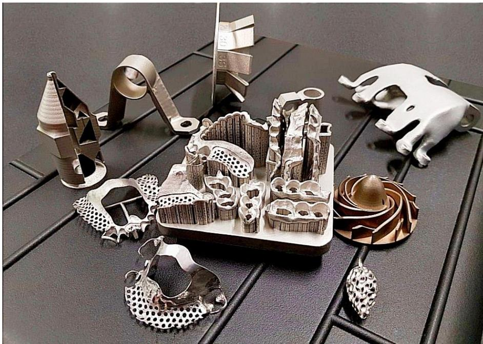
Fig. 2.1.1: Particolari prodotti tramite LPBF. [17]
