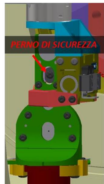
Figura 2.14: Presa del target con dettaglio dell'inserimento del perno di sicurezza nell'apposito foro.
