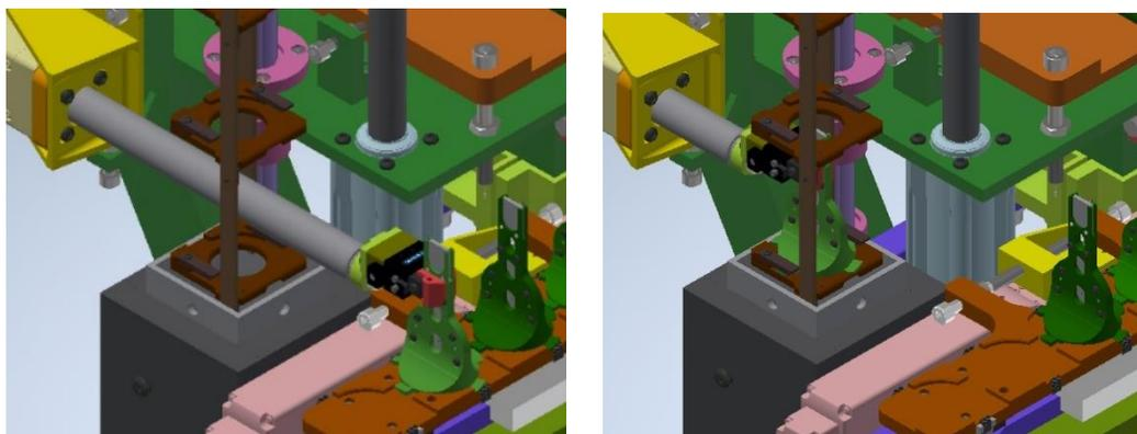
Figura 4.4: Sequenza di immagini raffigurante la presa dallo storage orizzontale e il rilascio nella stazione dello storage verticale.
