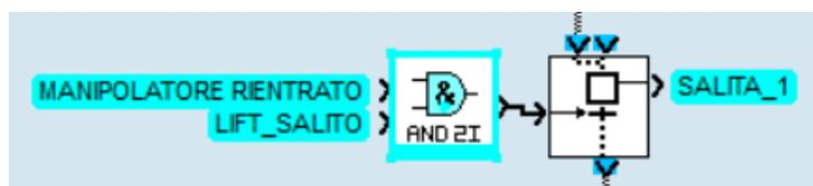
Figura 3.22: esempio di transizione con operazione logica AND per permettere il passaggio alla fase successiva solo se sono verificate contemporaneamente due condizioni
