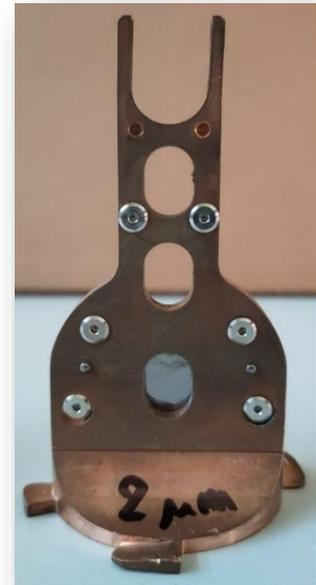
Figura 1.10 Target holder con lamina di HOPG nel foro inferiore
