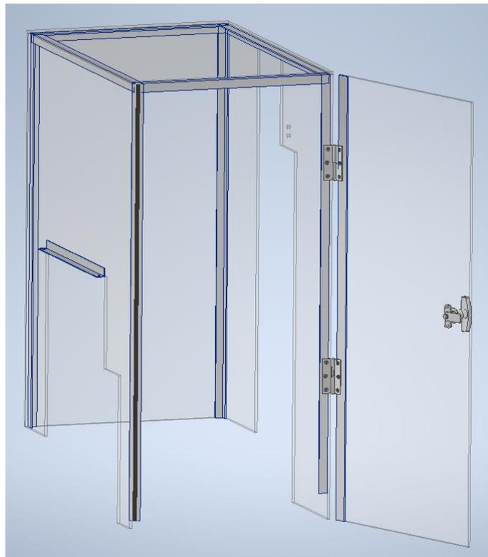
Figura 2.23: Sistema di protezione per gli organi di movimento del sistema di manipolazione
