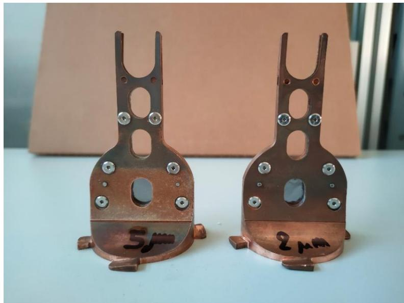
Figura 3.19: Target holder utilizzati per le prove di resistenza della lamina di grafite, come si legge sulla base dei target a sinistra la lamina utilizzata è di  $5\ \mu\text{m}$  mentre a destra è quella nominale di  $2\ \mu\text{m}$ .
