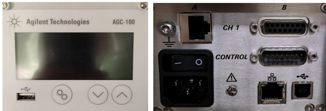
Figura 5.5: A sinistra il frontalino del driver del misuratore di pressione che permette di visualizzare l'andamento della pressione, mentre a destra la parte posteriore del driver dove si connette il cavo con i pin necessari a inviare i segnali di input al PLC.
