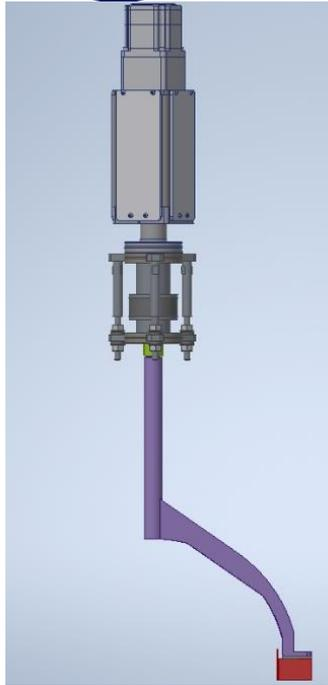
Figura 2.23: Complessivo comprendente il motore della Faraday cup e gli elementi per la trasmissione del moto
