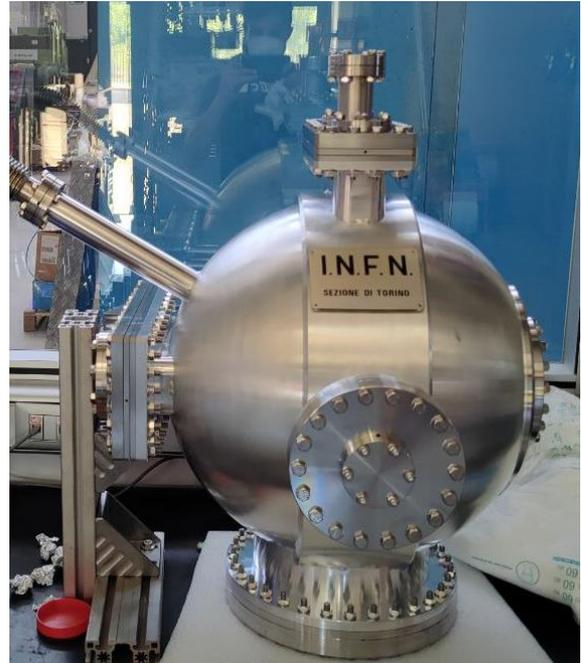
Figura 1.7: Camera di scattering
