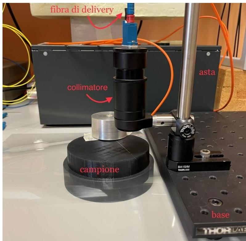
**Figura 8. 5:** Configurazione 2 della fibra di delivery del laser rispetto al campione.
