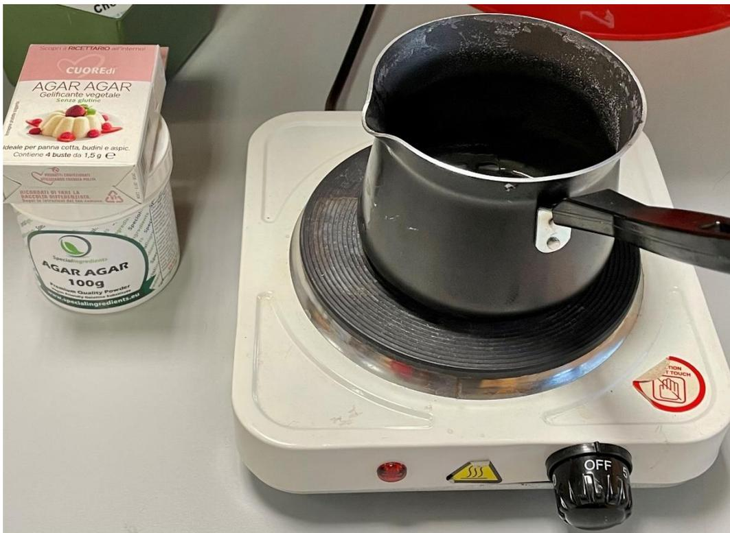
**Figura 8. 14:** Fornello da campeggio impiegato per fornire calore alla soluzione di acqua, agar e inchiostro, contenuta all'interno del pentolino.
