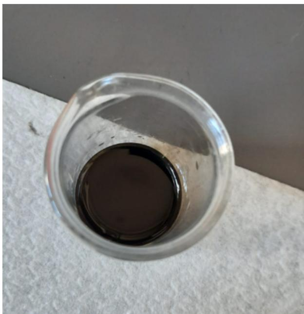
*Figura 10: soluzione di acetone,  $\text{AgNO}_3$ , fotopolimerizzatore e PHPS*
