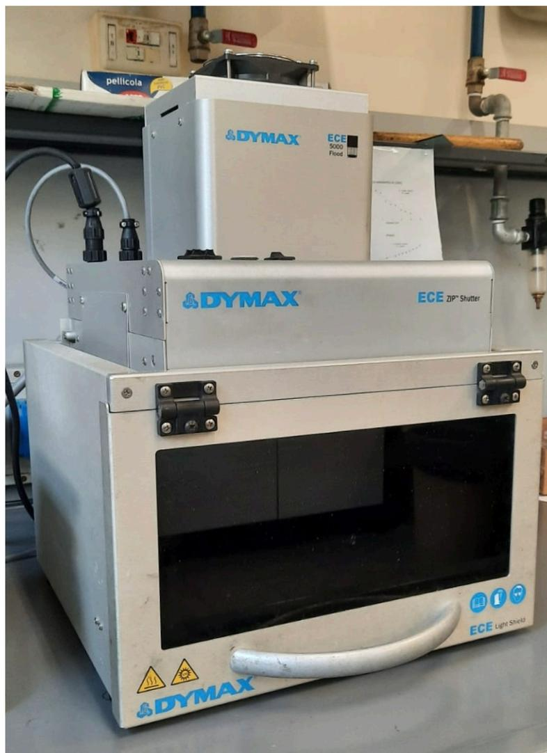
*Figura 15: foto della camera UV serie ECE utilizzata per il processo di sintesi delle nanoparticelle d'argento*
