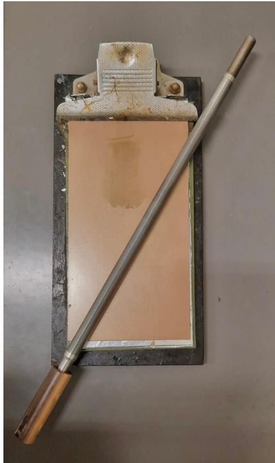
*Figura 12: immagine dello stendifilm manuale utilizzato*
