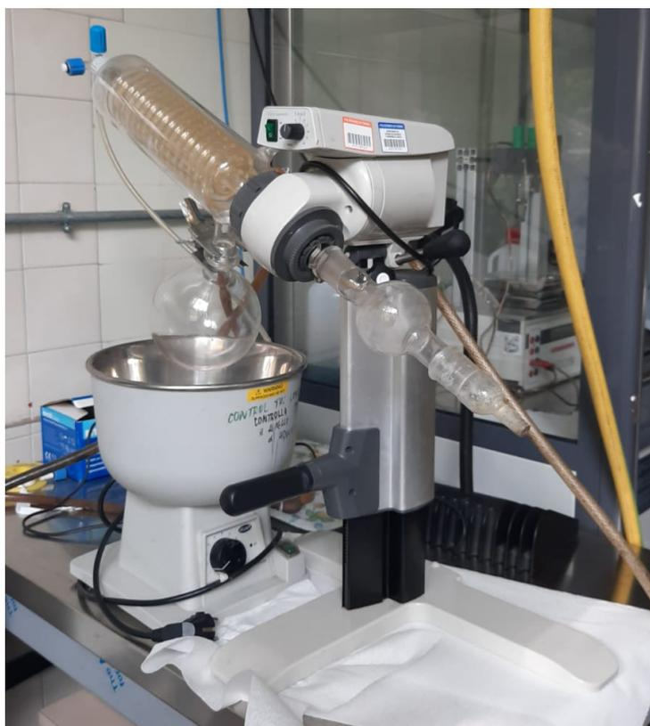
*Figura 11: immagine del Bibby Scientific RE300 Rotary Evaporator (o rotavapor) utilizzato*
