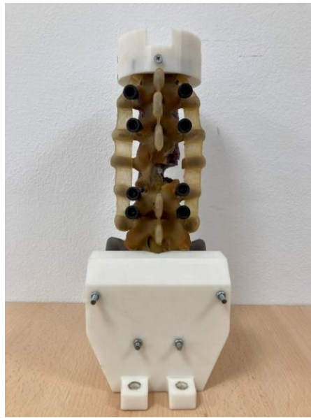
Figura 30. Fantoccio fornito da Sawbones, che riproduce il tratto lombare del rachide.
