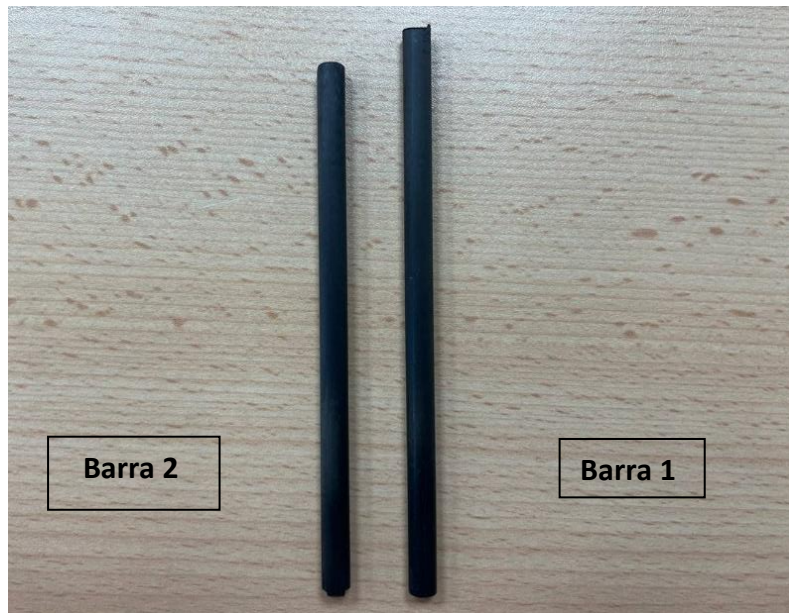
Figura 21. Barre in carbonio utilizzate nel test di flessione a 4 punti.
