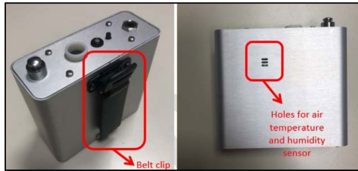
Figura 2.10: A sinistra, la parte posteriore ed a destra, la parte anteriore dell'unità DAP [10].
