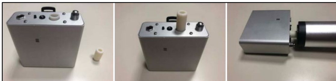
Figura 2.12: Microfono in aria dell'unità DAP accoppiato con un calibratore di pressione [11].
