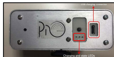
Figura 2.9: Pannello posteriore dell'unità DAP [11].
