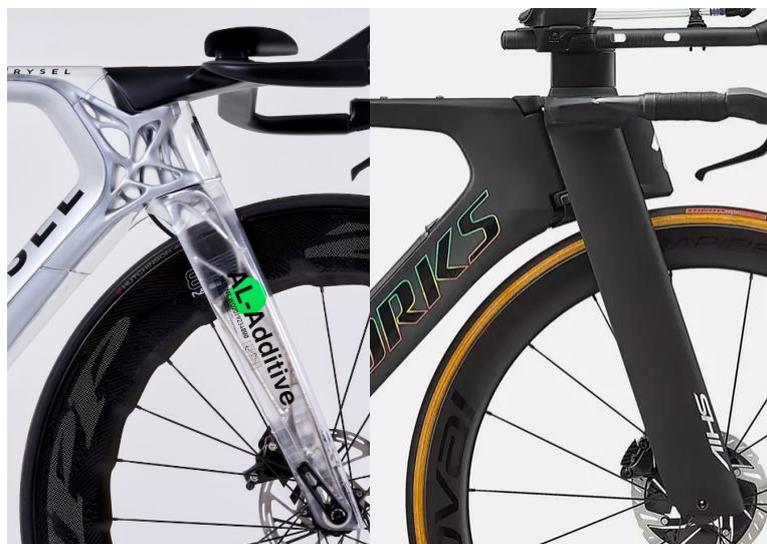
FIG. 6 - CONFRONTO BICI AM CON BICICLETTA IN FIBRA DI CARBONIO [5]
