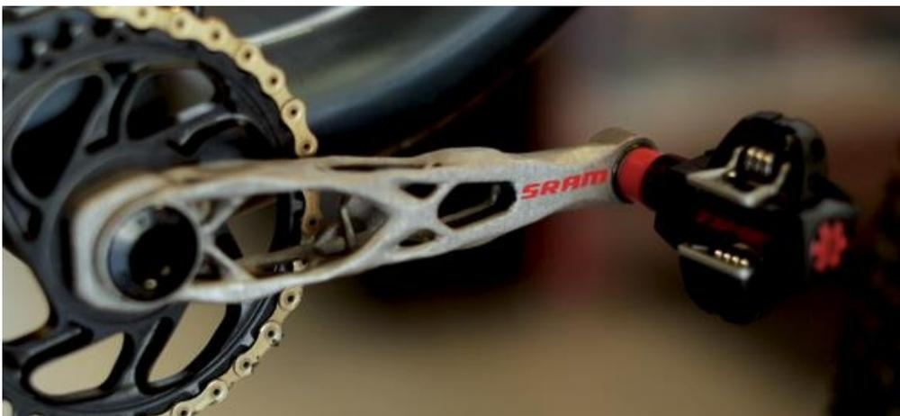
**FIG. 3 - PEDIVELLA REALIZZATA MEDIANTE FABBRICAZIONE ADDITIVA [4]**
