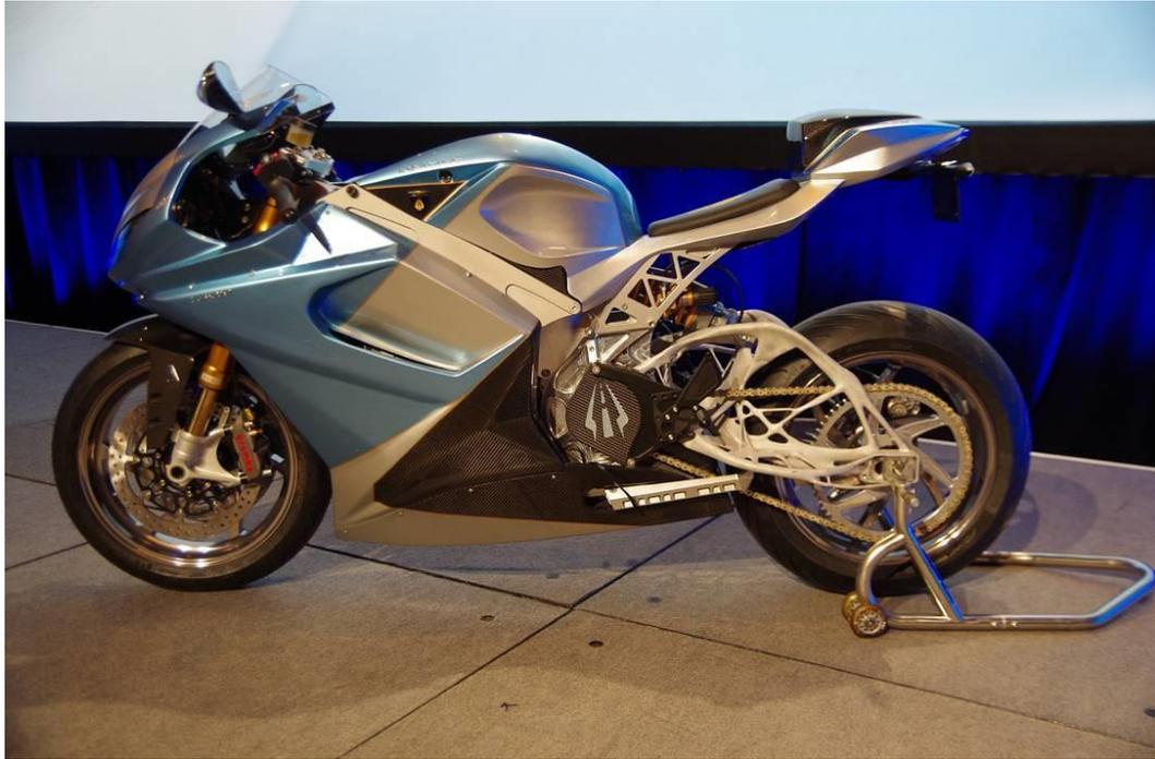
FIG. 8 - SUPERBIKE LIGHTNING CON FORCELLONE PRODOTTO MEDIANTE AM [8]
