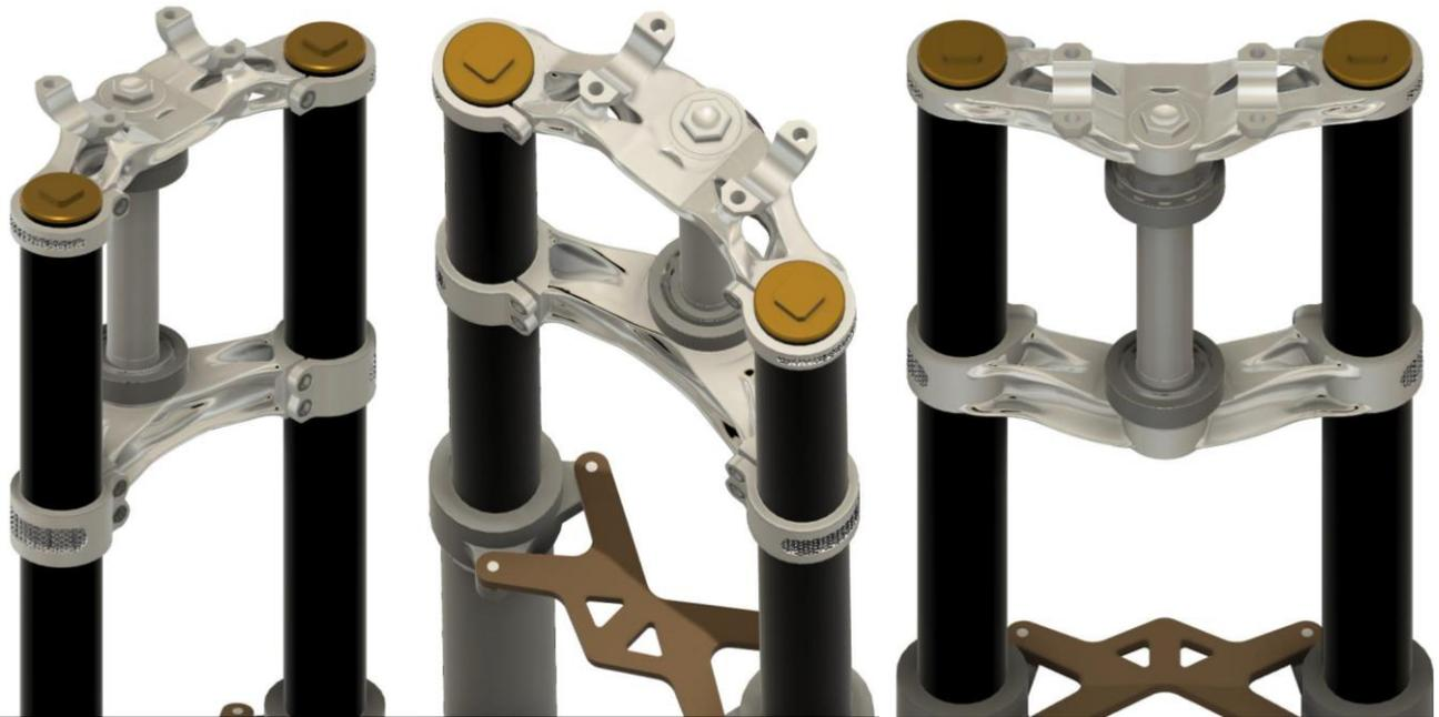
FIG. 102 - ASPETTO DEFINITIVO DEL SISTEMA DI STERZO
