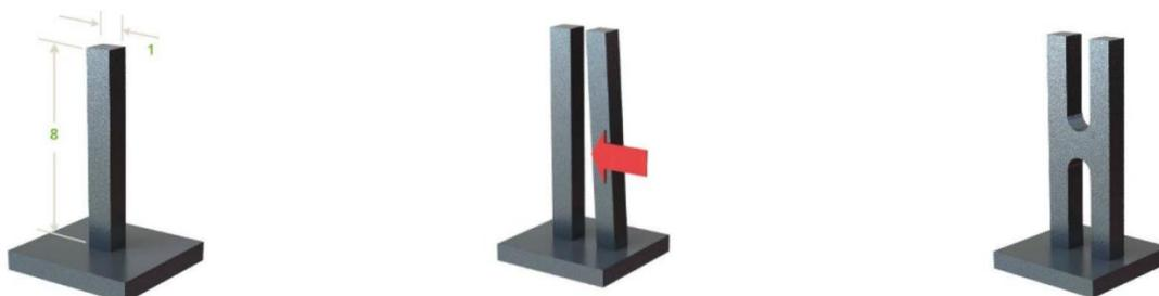
FIG. 21 - PARETI ALTE CON SEZIONE RIDOTTA [19]
