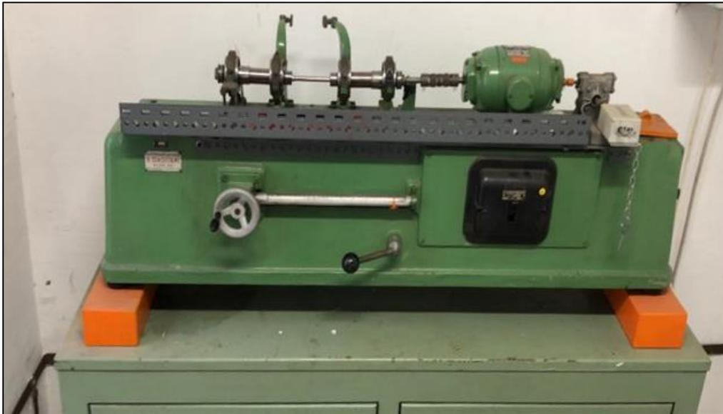
*Figura 43: Macchina per le prove a flessione rotante*
