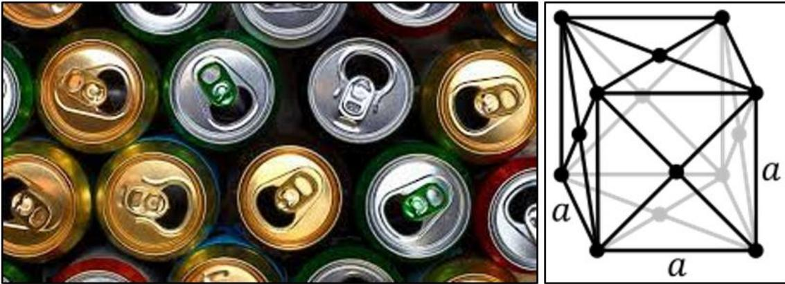
Figura 1: Lattine e Struttura cristallina cubica a facce centrate dell'alluminio
