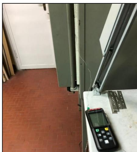
*Figura 31: Data logger all'esterno collegato con la termocoppia*
