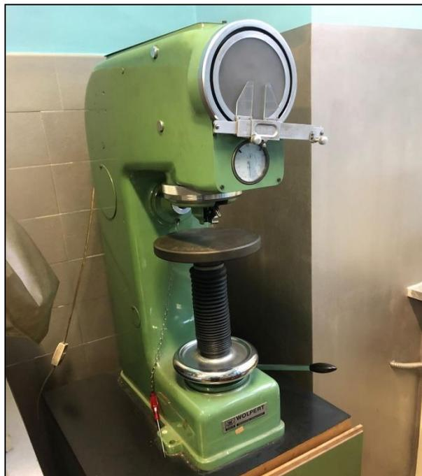
Figura 101: Indente utilizzato per misurare la durezza
