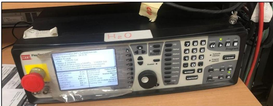
Figura 58: Controller MTS flextest
