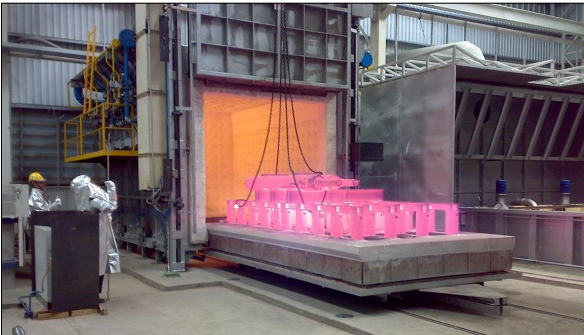
*Figura 27: Forno industriale per i trattamenti termici*
