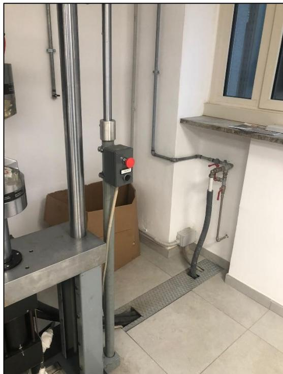
*Figura 62: Tasto d'arresto del circuito (a sinistra) e rubinetto del raffreddamento dell'acqua (a destra)*
