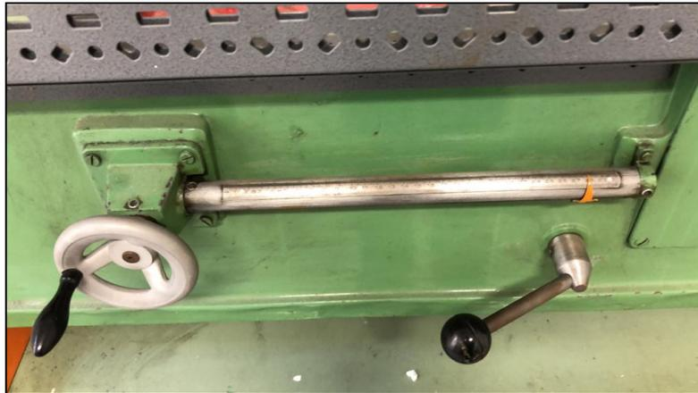
Figura 46: Volantino di manovra per la regolazione del carico
