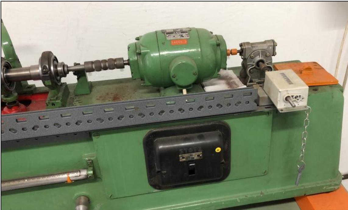
*Figura 48: Motore (in verde) contagiri (in bianco) e sistema di arresto macchina (in nero)*
