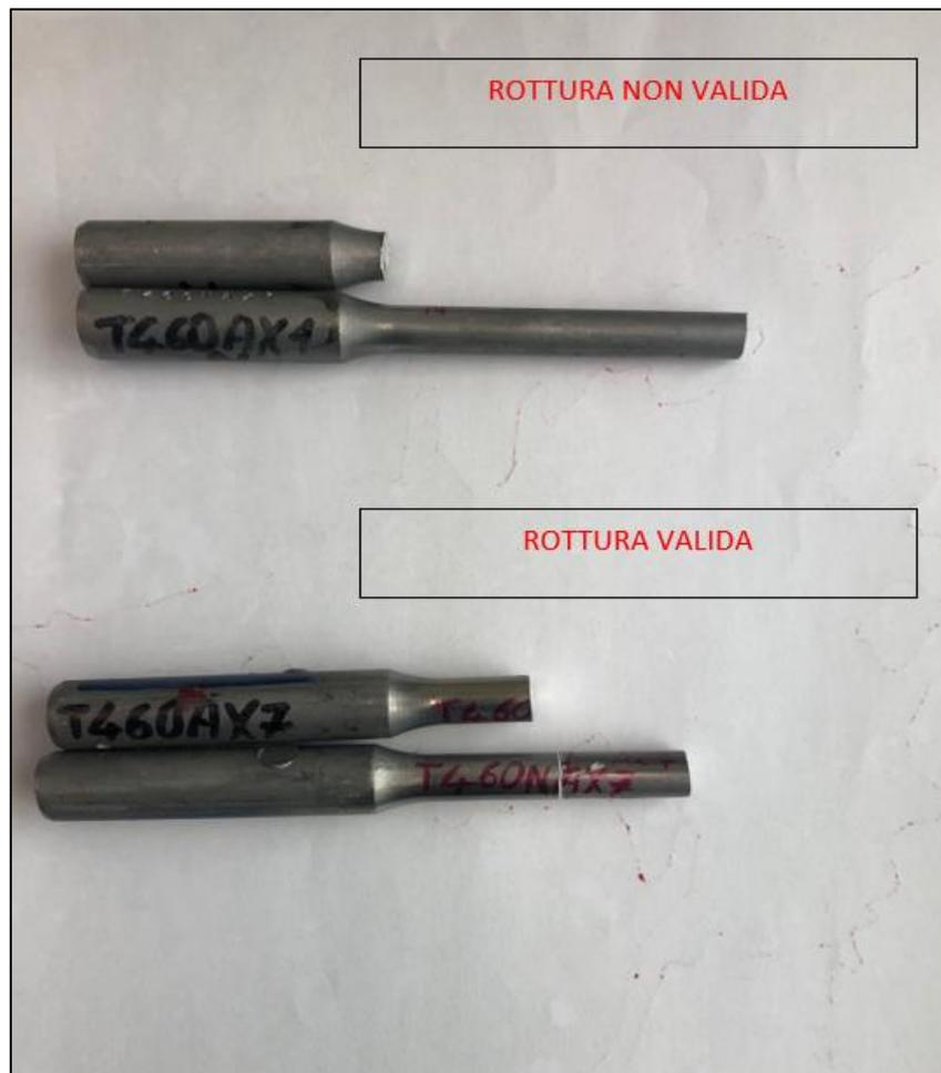
Figura 73: Tipologie di rotture
