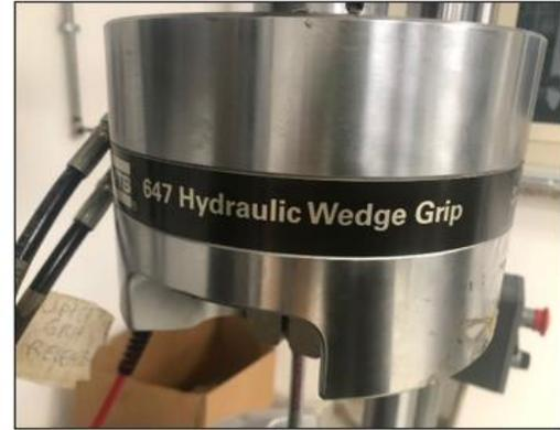
*Figura 60: Morsetti per il blocco del provino*
