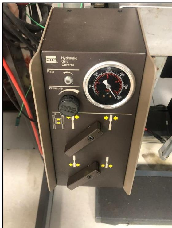
Figura 59: Manopole per la chiusura idraulica dei morsetti
