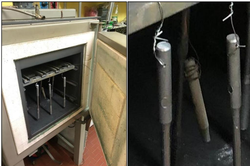
*Figura 30: Dettaglio della termocoppia all'interno del forno*
