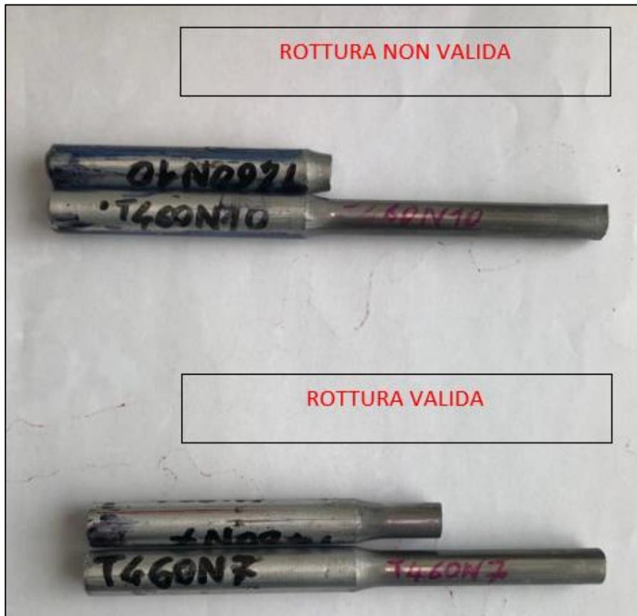
Figura 50: Tipologie di rotture
