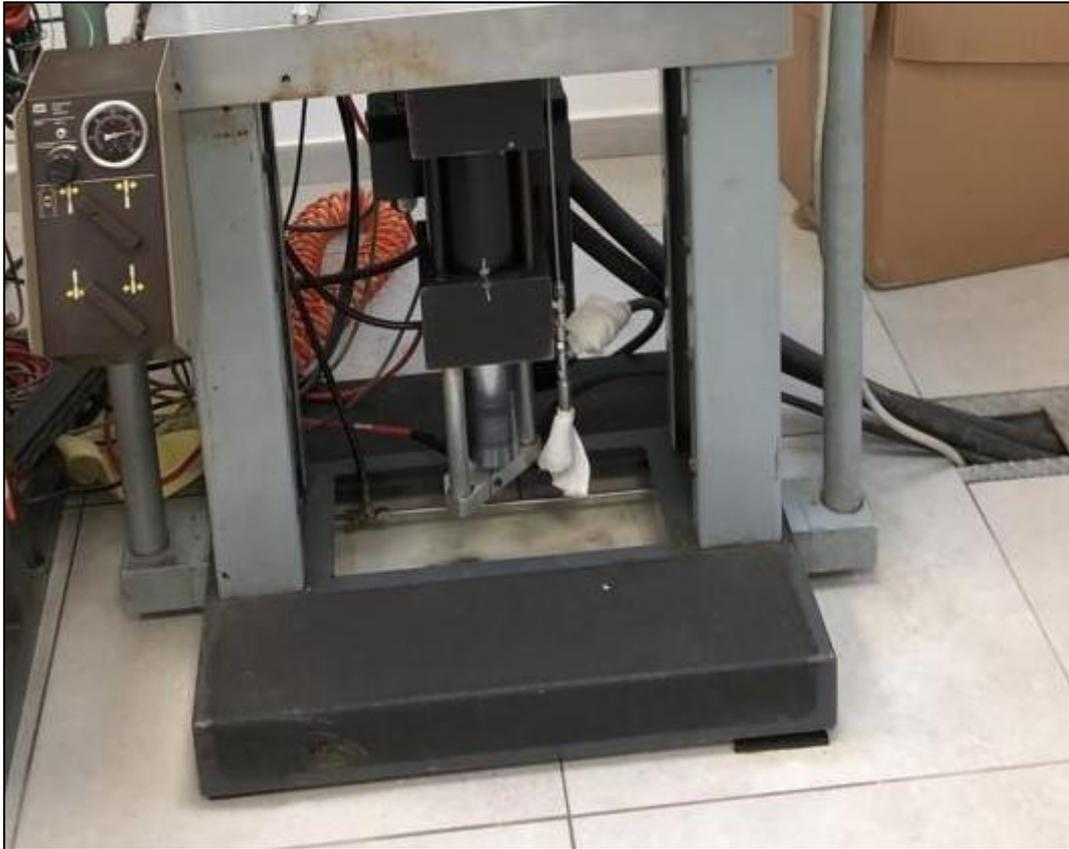
*Figura 61: tubi di alimentazione dell'olio e dell'acqua (raffreddamento)*
