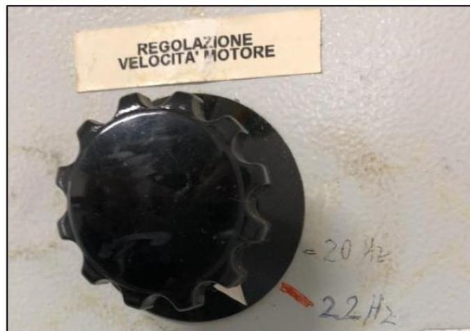
Figura 47: Cabina di avvio prova e dettaglio sulla manopola di regolazione velocità motore
