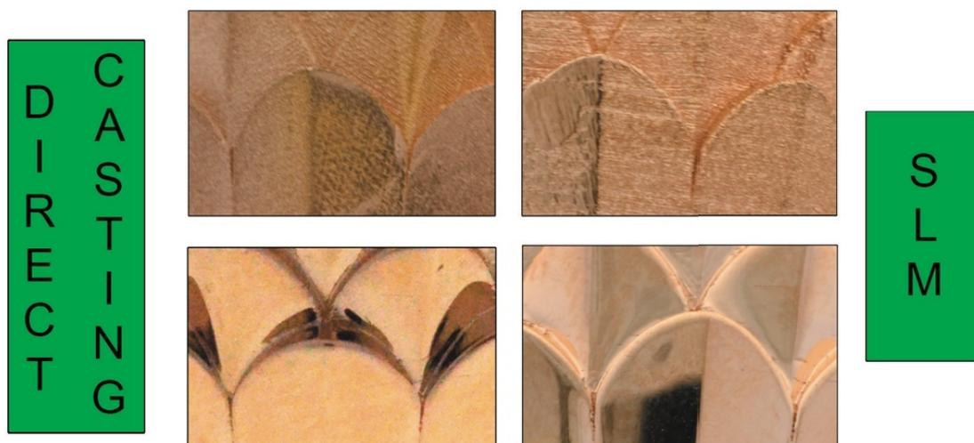
*Figura 20 : Dettaglio di un gioiello prodotto con due tecnologie: direct casting a sinistra e SLM a destra, as built e dopo una fase di post-processing.[36]*
