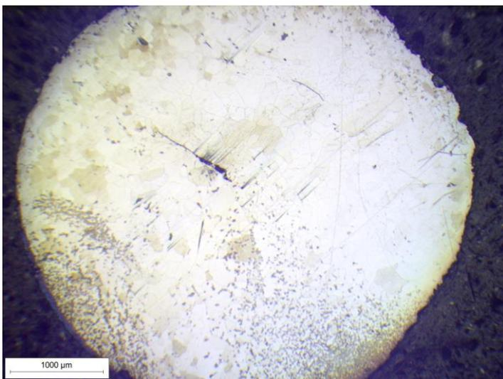
Figura 4-26 Vitone del cane, dettaglio sezione trasversale, struttura ferritica con prevalenza di grani grandi
