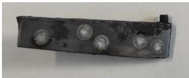
Figura 4-19 Molla del cane dopo analisi chimica
