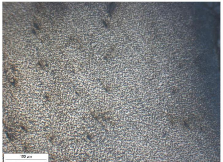
Figura 4-70 Molla dello scatto, dettaglio zona A dopo attacco metallografico, struttura bainitica-ferritica
