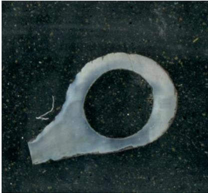
Figura 4-60 Scansione delle sezioni della molla dello scatto dopo inglobatura MS-2.
