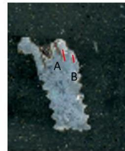
Figura 4-98 Impronte microdurezze vite molla dello scatto
