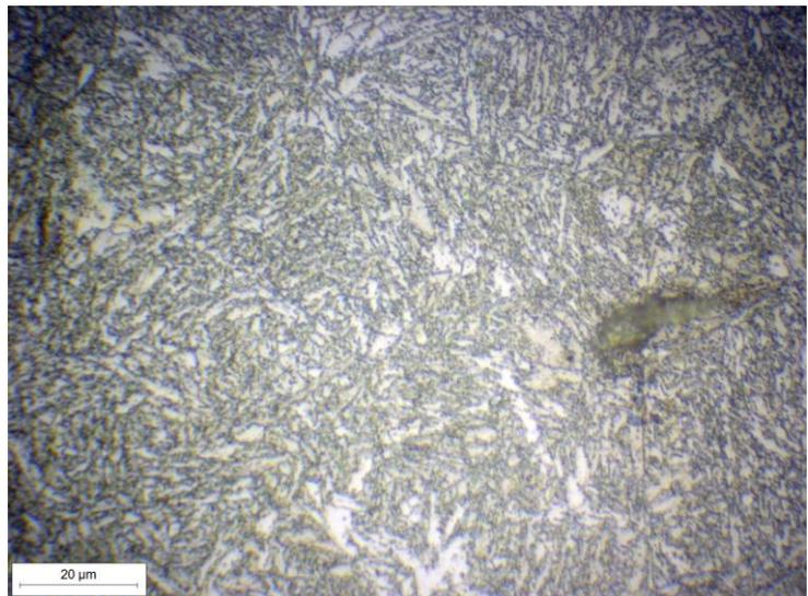
Figura 4-13 Molla del cane, dettaglio zona C dopo attacco metallografico, struttura bainitica con rare isole di ferrite
