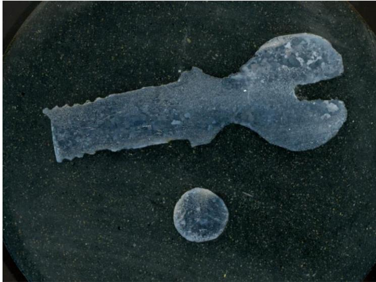
Figura 4-22 Scansione delle sezioni del vitone del cane dopo inglobatura. VC-1 (in basso) e VC-2 (in alto).
