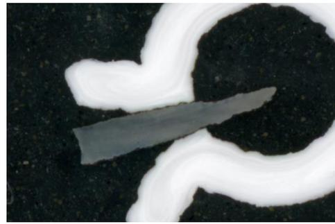
Figura 4-61 Scansione delle sezioni della molla dello scatto dopo inglobatura MS-1.
