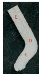
banda) più sensibile all'attacco, orientata secondo l'asse di forgiatura, e che si presume che ciò corrisponda ad una segregazione chimica (fig.4-16).
