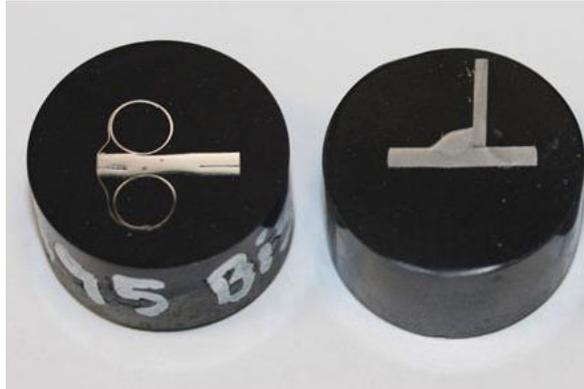
Figura 3-8 Esempi di provini inglobati.
