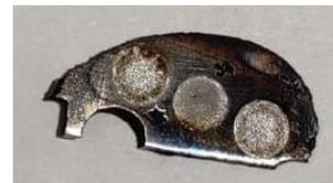
Figura 4-57 Piattello del cane dopo analisi chimica
