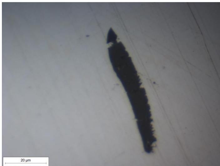
**Figura 4-66** Molla dello scatto, sezione longitudinale, dettaglio direzione inclusioni zona D
