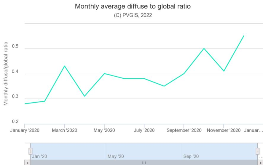
FIGURA 1.13 – % DI IRRADIAZIONE DIFFUSA SUL TOTALE PRESSO L'ENERGY CENTER NEL 2020
