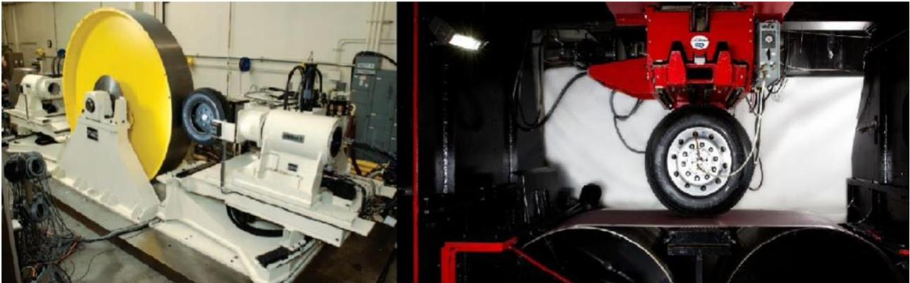
Figura 10: Confronto tra Macchine Prova Pneumatici di tipo a rullo (a sinistra) e a nastro (a destra).
