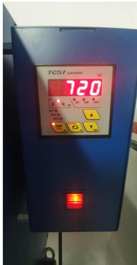
Figura 6: forno per trattamento termico di invecchiamento provini
