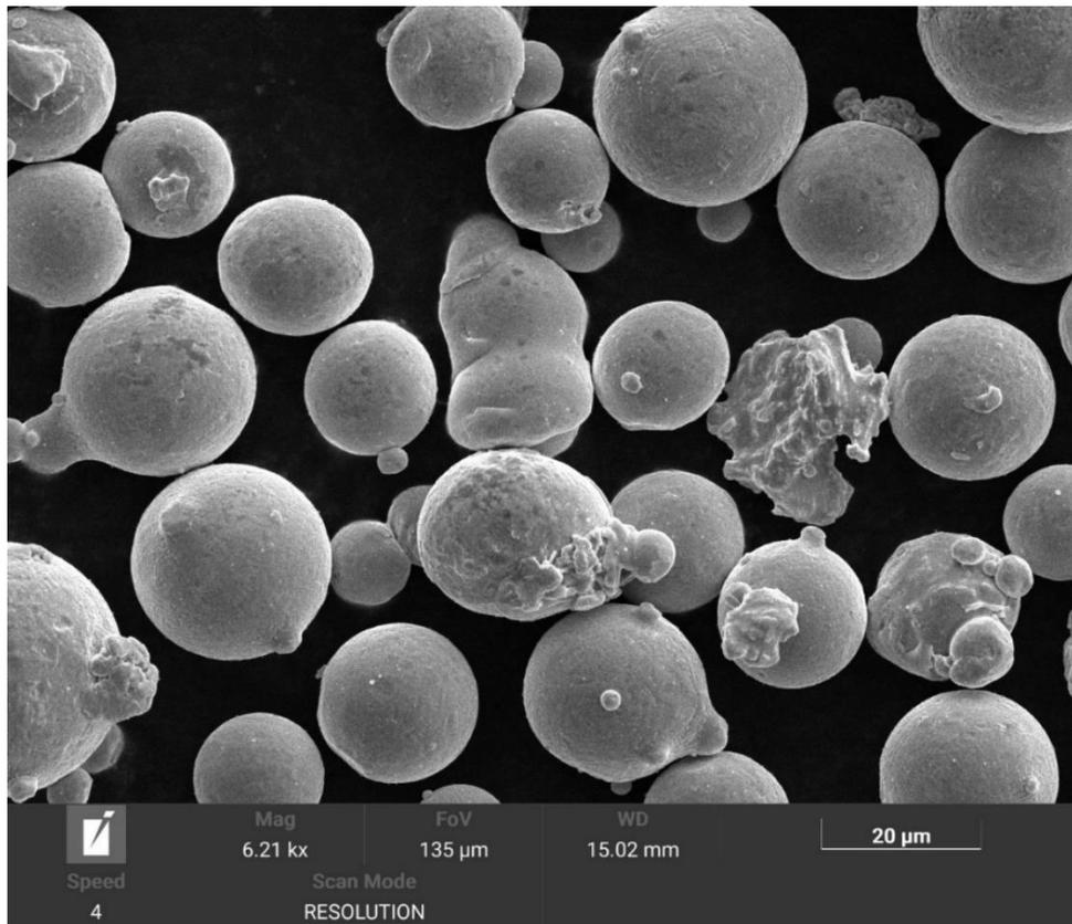
Dalle immagini ci si rende conto di quanto fine possa essere la granulometria di queste polveri. Siamo nell'ordine di pochi micrometri e benché sembri trattarsi di una polvere piuttosto omogenea non si può escludere che tutto ciò che si discosta dalla tipica forma sferica del granello di polvere possa poi avere ripercussioni sulla fusione ad opera del laser in fase di fabbricazione additiva di cui ci si accinge a discutere.
