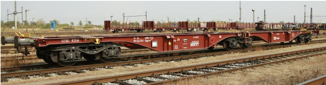
Figura 4.1: Un carro pianale articolato dotato di tre carrelli Y25
