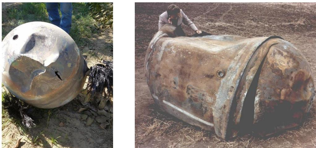
*Figura 1.6: serbatoio ritrovato in California nel 2018 e appartenuto ad un satellite Iridium dismesso nel 1990. Destra: serbatoio principale del secondo stadio di un razzo Delta 2 atterrato vicino a Georgetown, Texas, USA, il 22 gennaio 1997. Credit: FoxNews, ESA.*
