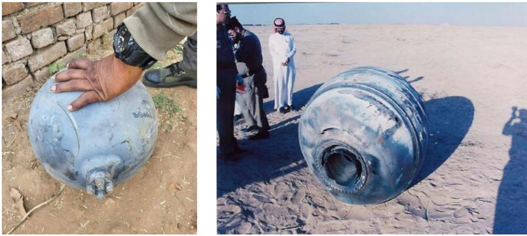
*Figura 1.5: Sinistra: serbatoio di titanio ritrovato a Gujarat (India), Maggio 2022. Destra: serbatoio dello stadio superiore del lanciatore della missione GPS NAVSTAR 32 lanciato nel 1993 e caduto in Arabia Saudita nel 2001. Credit: Indianexpress, Wikipedia.*
