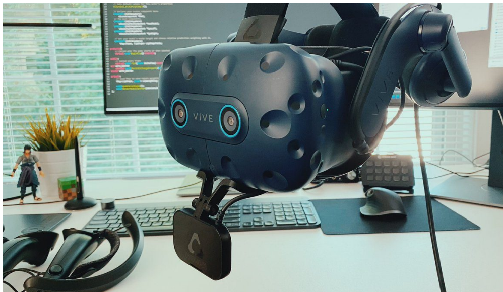
Figura 5.5: Dispositivo Head Mounted Display (HMD) HTC VIVE Pro con annesso hardware per il Facial Tracking.
