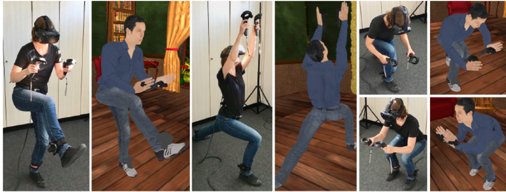
Figura 2.3: Esempi di Full Body Motion Reconstruction tramite IK con HTC VIVE headset, Tracker e controller [39].
