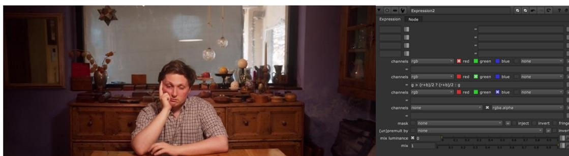
Figura 79: Despill effettuato con un'espressione di confronto tra il canale verde e la media dei canali rosso e blu.
