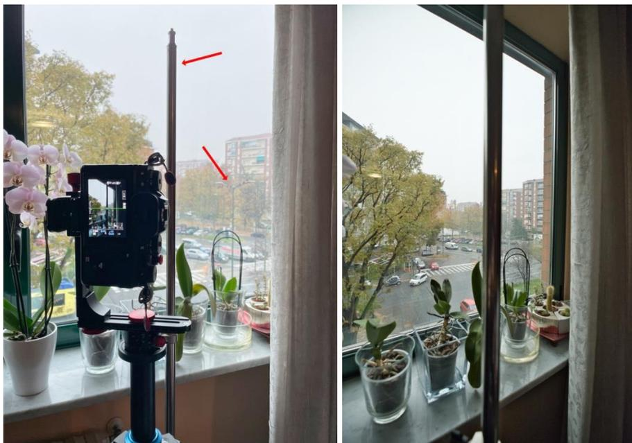
*Figura 28: Si usano uno stativo ed un palo come riferimenti (a sinistra) e si allineano al centro del frame (a destra).*
