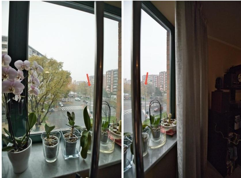
*Figura 29: Quando la camera non è nel punto nodale, ci sarà parallasse ruotando la testa orizzontalmente.*
