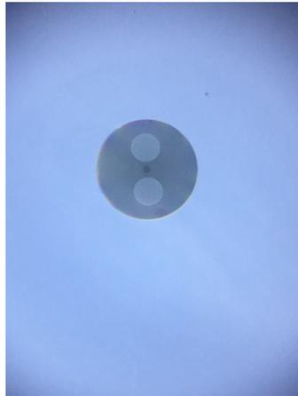
Figura 3.52. Foto di una sezione trasversale di una fibra ottica di tipo PMF
