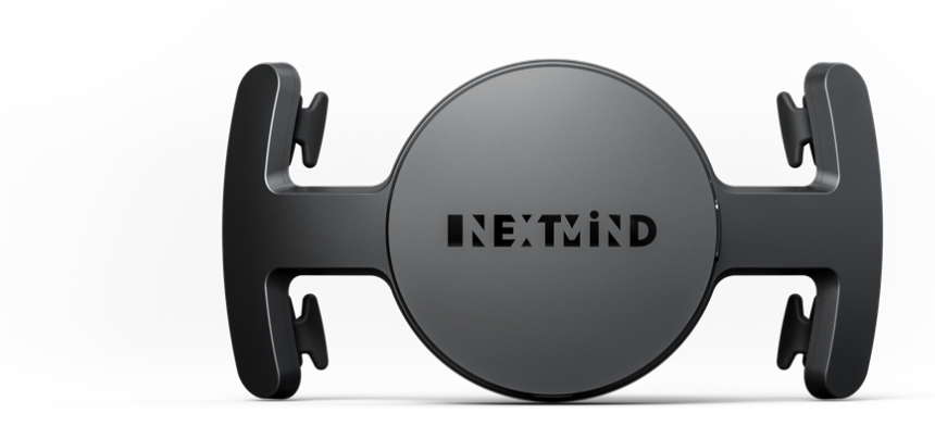
Figura 3.2. Sensore NextMind basato su tecnologia EEG-SSVEP
