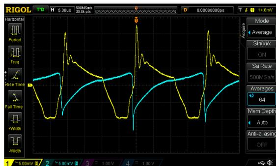
Figura 4.5: Segnali  $V_a$  con la presenza di sovratensioni (in giallo) e  $V_b$  (in blu)
