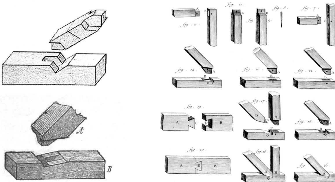
Figure 22: Tenon and mortise connection between rafter and tie beam (left above (Gandolfo, 1869); Left below (Breymann, 1985); Right: *Encyclopédie ou Dictionnaire raisonné des sciences, des arts et des métiers*, 1765)
