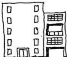
L'addizione: prevede azioni dove si rinuncia a demolire, azioni volte ad aggiungere dei componenti all'edificio esistente.
