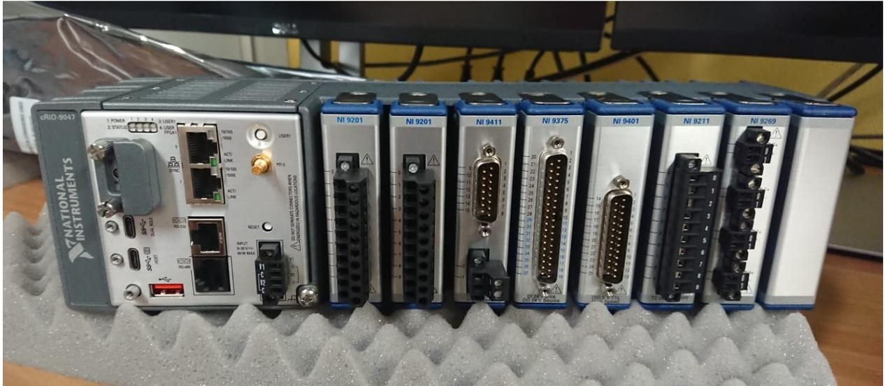
Figura 9: Il CompactRIO-9047 montato sul banco prova.
