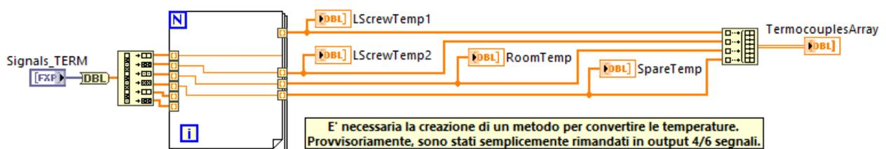
Figura 3.10: *Block Diagram del subVI che verrà dedicato alla conversione dei segnali di tensione provenienti dal modulo delle termocoppie.*
