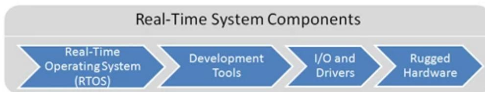
Figura 12: *Elementi principali che costituiscono un sistema real-time.*
