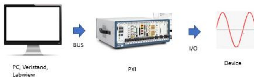
Figura 19 configurazione Labview, NI Hardware e utilizzatore
