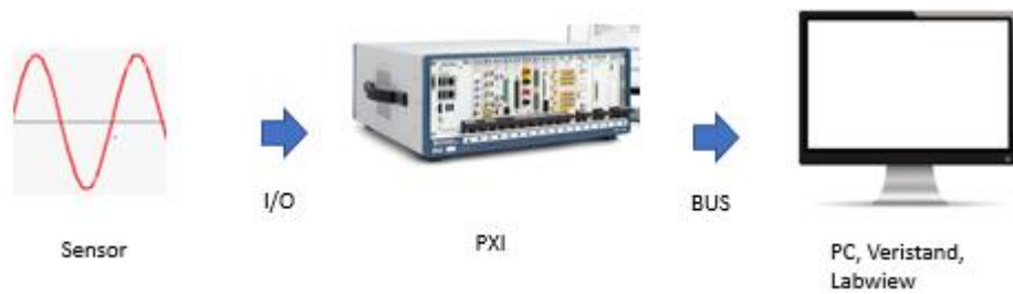
Figura 20 configurazione Labview, Ni Hardware e sensore
