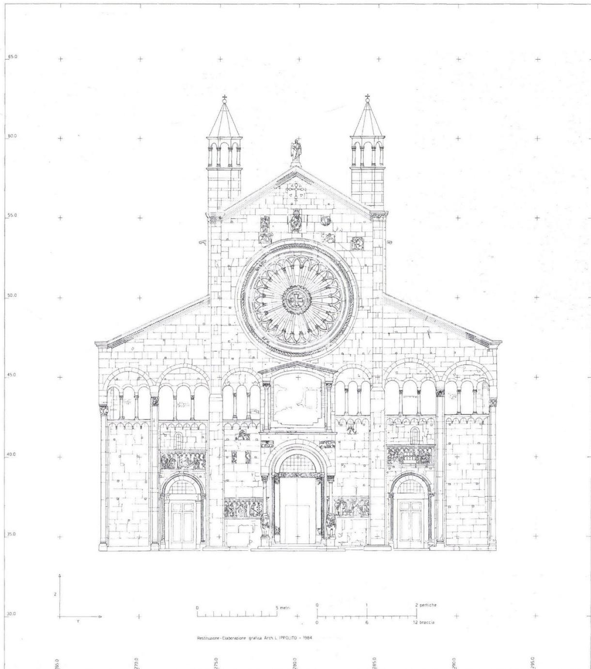
Fig. 18 - Docci M., Maestri D. (2009). Duomo di Modena. Rilevamento fotogrammetrico della facciata..
