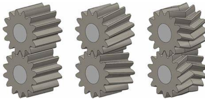
Figura 1.5: Ingranaggi cilindrici, elicoidali e a spina di pesce. (Immagine tratta da [3]).
