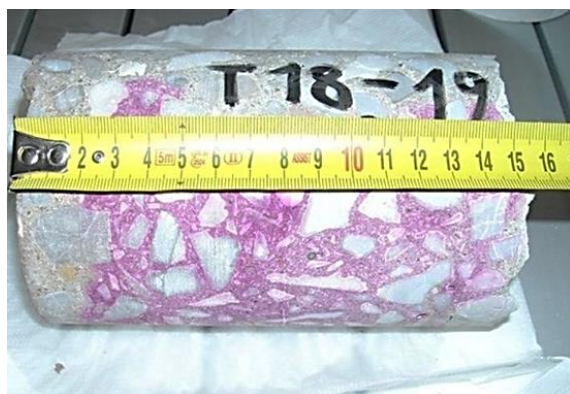
Figura 3.17 – Misura sul grado di carbonatazione su una carota di calcestruzzo.
