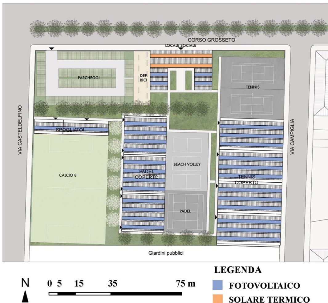
Fig. 69 - Rappresentazione planimetrica del centro sportivo con indicazione delle coperture occupate dagli impianti di produzione da FER
