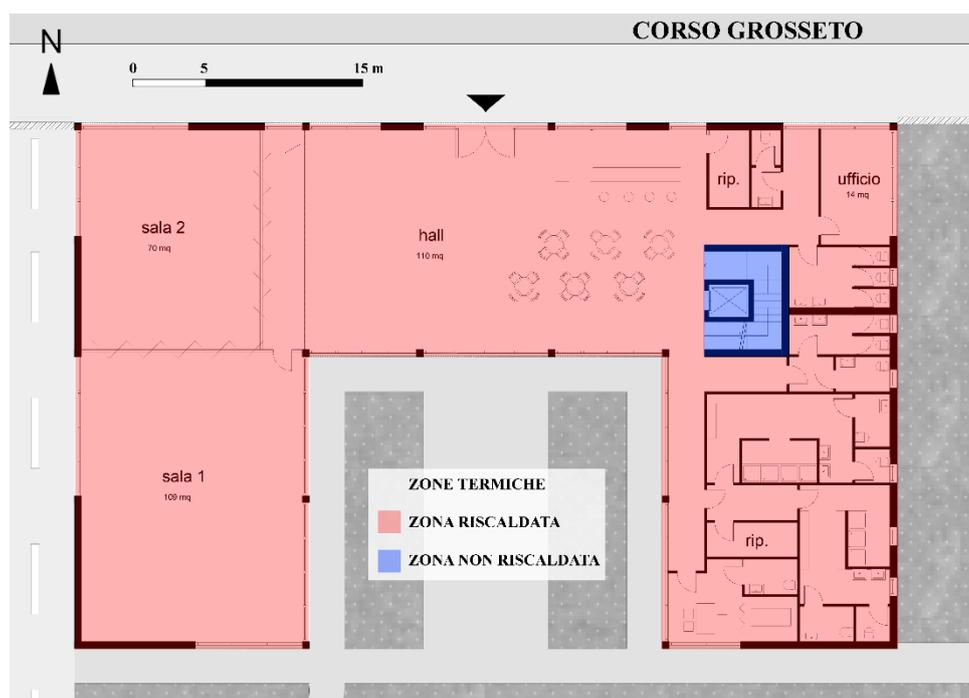
Fig. 22 - Elaborazione Pianta Piano Terra dell'edificio sociale con indicazione della suddivisione in zone termiche
