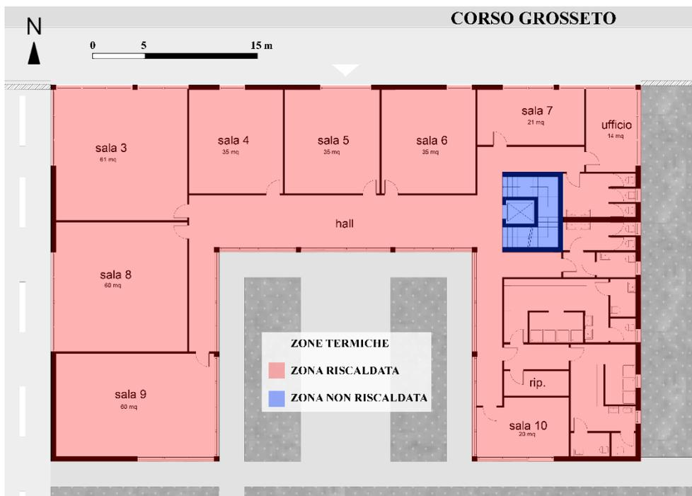
Fig. 23 - Elaborazione Pianta Piano Primo dell'edificio sociale con indicazione della suddivisione in zone termiche
