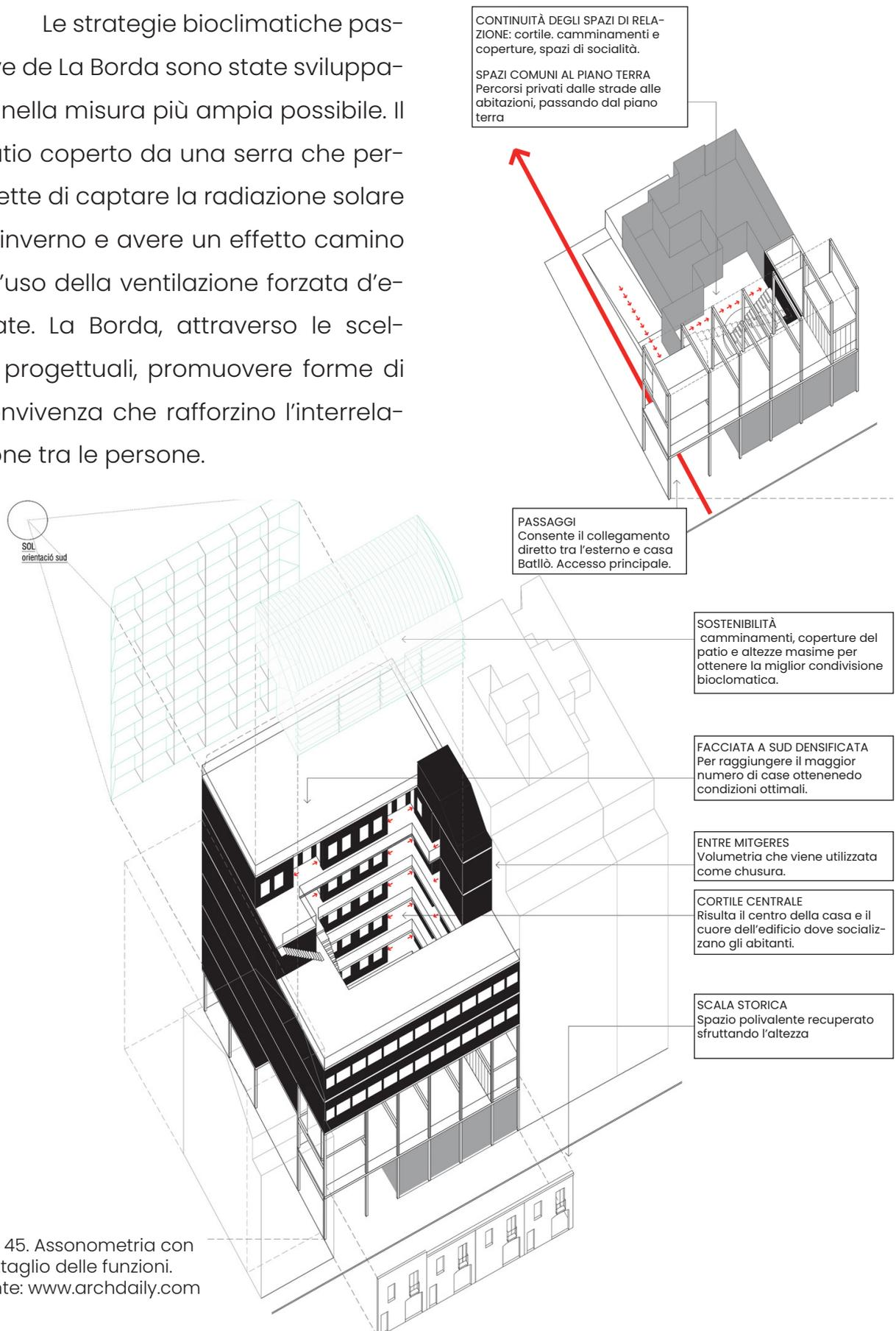
Fig. 45. Assonometria con dettaglio delle funzioni.
