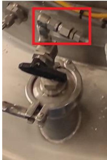
*Figura 27: Sistema di collegamento tra tubo di distribuzione e camera di atomizzazione*
