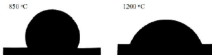
Figura 40: Bagnabilità della goccia in funzione della temperatura
