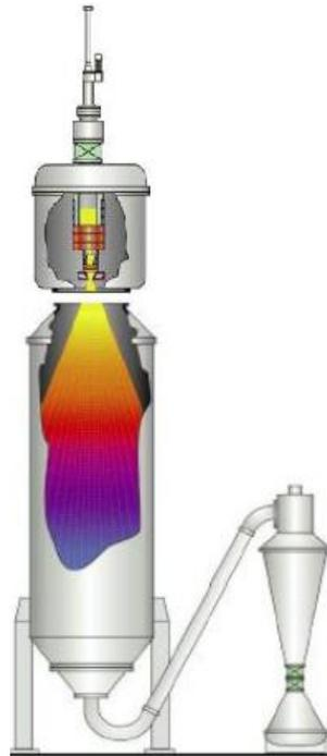
Figura 10: Schema impianto con tecnologia fusoria VIGA-CC
