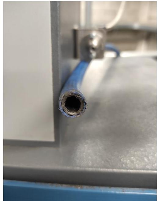
Figura 20: Tubo di trasporto delle particelle al di fuori dello spruzzatore
