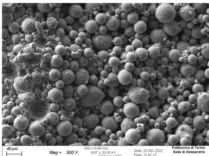
Figura 82: Micrografia delle particelle AlSi10Mg/TiB<sub>2</sub>
