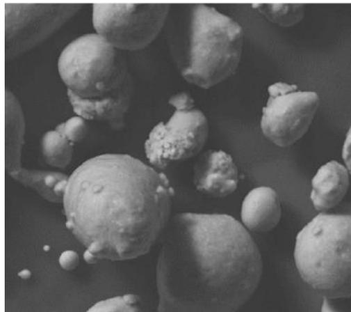
Figura 50: Microstruttura per lega A205
