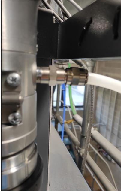
*Figura 26: Sistema di collegamento tra tramoggia e tubo di distribuzione*
