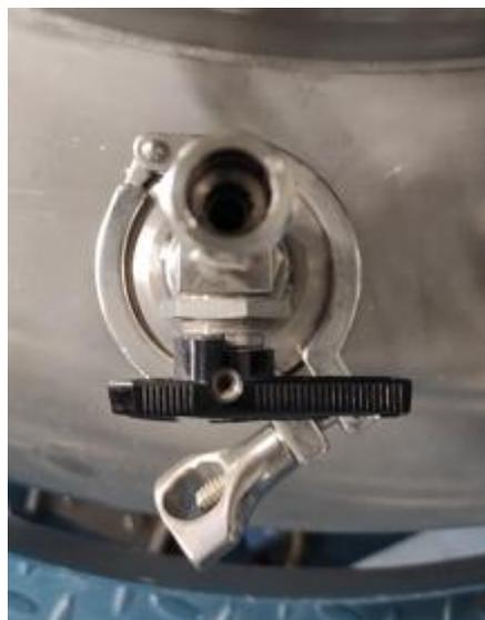
*Figura 28: Nuovo sistema di collegamento tra tubo di distribuzione e camera di atomizzazione*
