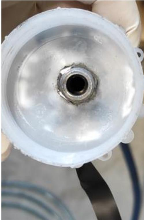
*Figura 21: Sezione ristretta in corrispondenza dell'uscita del tubo*
