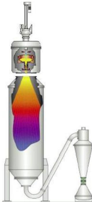
Figura 12: Schema impianto con tecnologia fusoria PIGA
