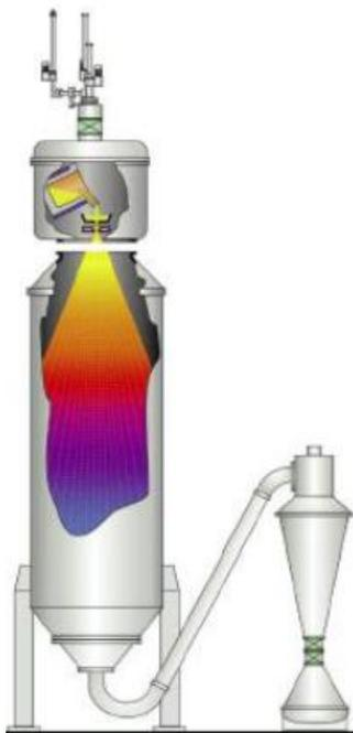
Figura 8: Schema impianto con tecnologia fusoria VIGA mobile
