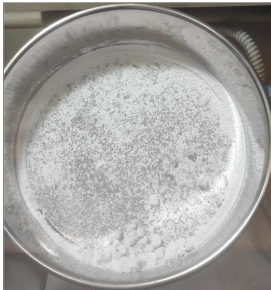
Figura 23: Setaccio contenente polveri Al<sub>2</sub>O<sub>3</sub>
