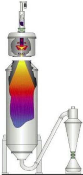
Figura 11: Schema impianto con tecnologia fusoria EIGA
