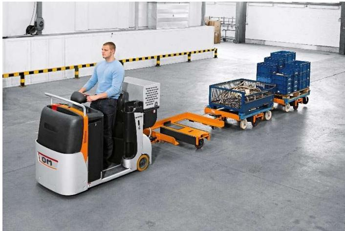
*15 Esempio di trattore elettrico utilizzato per l'asservimento delle linee di assemblaggio*
