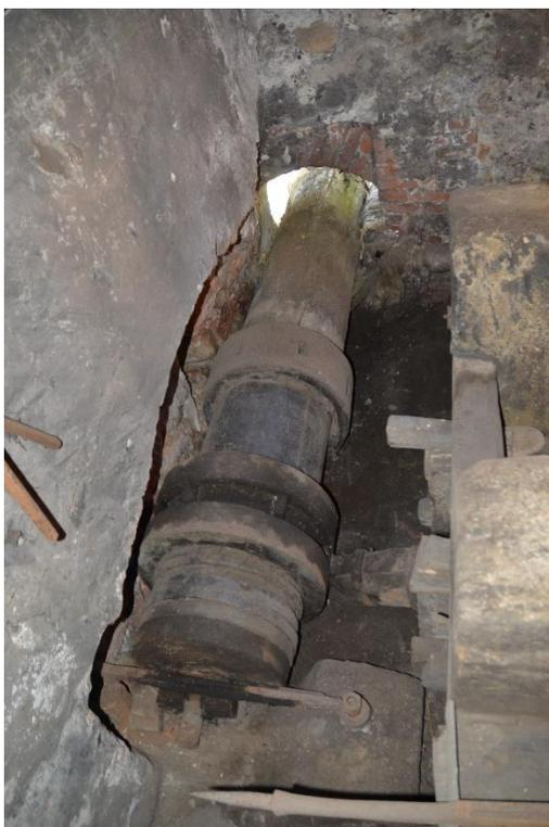
Fig. 3.8a – albero solidale alla ruota idraulica
