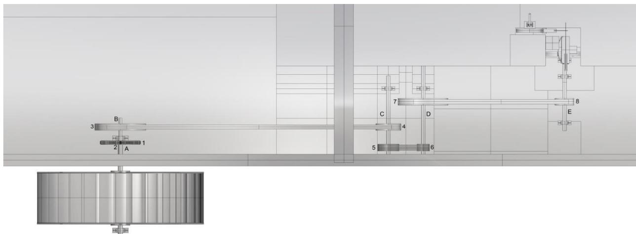
Fig. 4.4 – vista generale del sistema di trasmissione del moto
