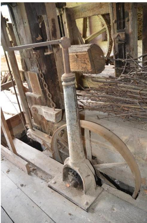
Fig. 4.16a – meccanismo regolazione manuale
