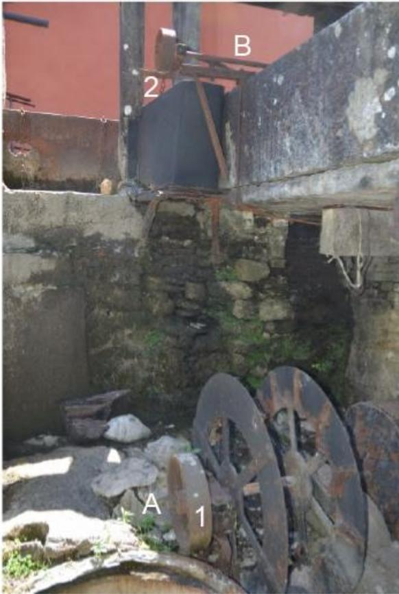
Fig. 3.18a – ruota idraulica e pulegge
