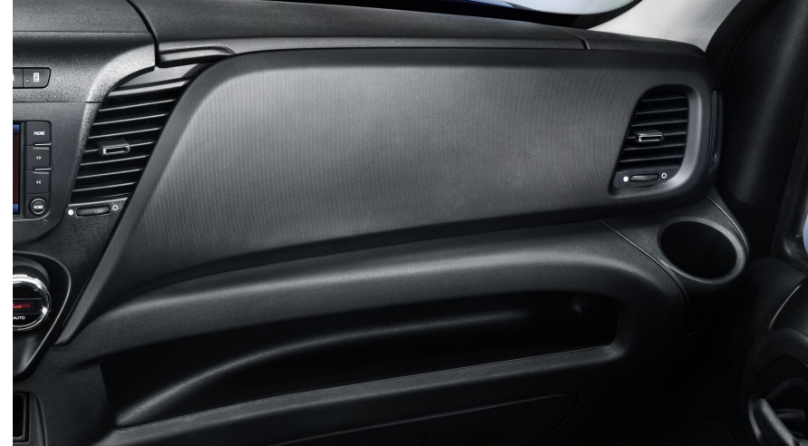
Lato dx: vano superiore e vano inferiore a comparsa, divisi da un lungo vano aperto.
