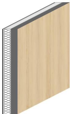
Il progetto è partito dalla spogliatura totale degli interni. Era necessario sostituire l'imbottitura originale per isolamento di lana di roccia, per migliorare le prestazioni termiche
