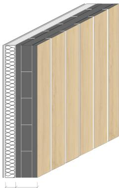
Costruita principalmente in pannelli di legno lamellare, i quali oltre ad essere dotati di ottime caratteristiche termiche, sono autoportanti, eliminando così la necessità di un telaio
