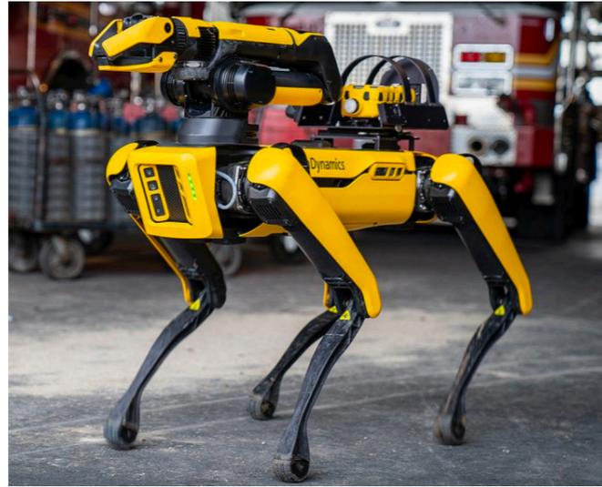
*Il robot quadrupede SPOT di Boston Dynamics è uno degli esempi più rinomati di robot autonomo.*
