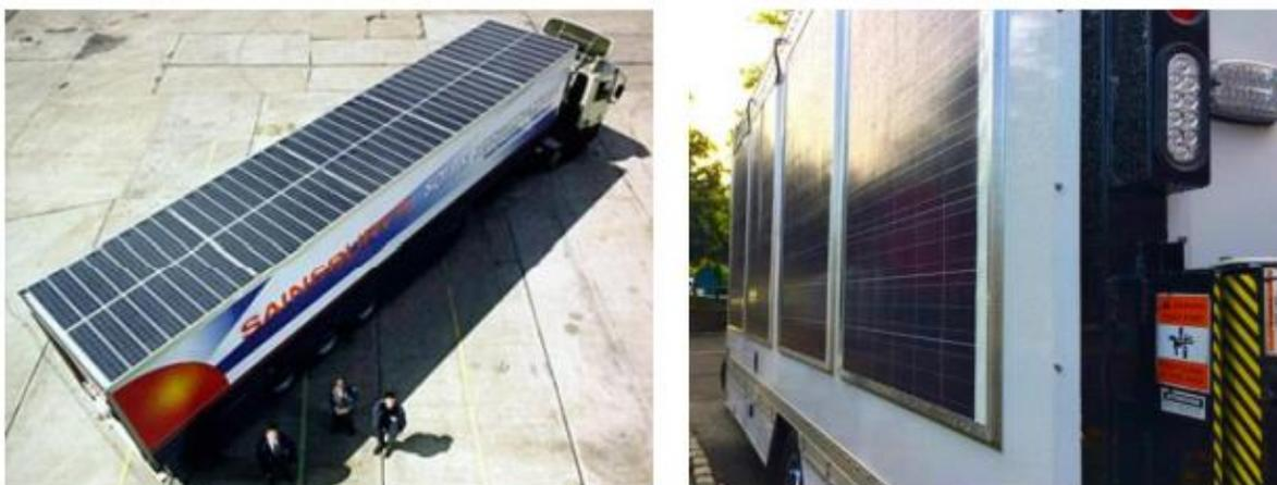
*Figura 22: Esempio di solare fotovoltaico montato su camion per il trasporto refrigerato*
