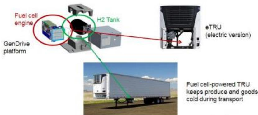
Figura 21: Configurazione prototipo alimentato attraverso fuel cell
