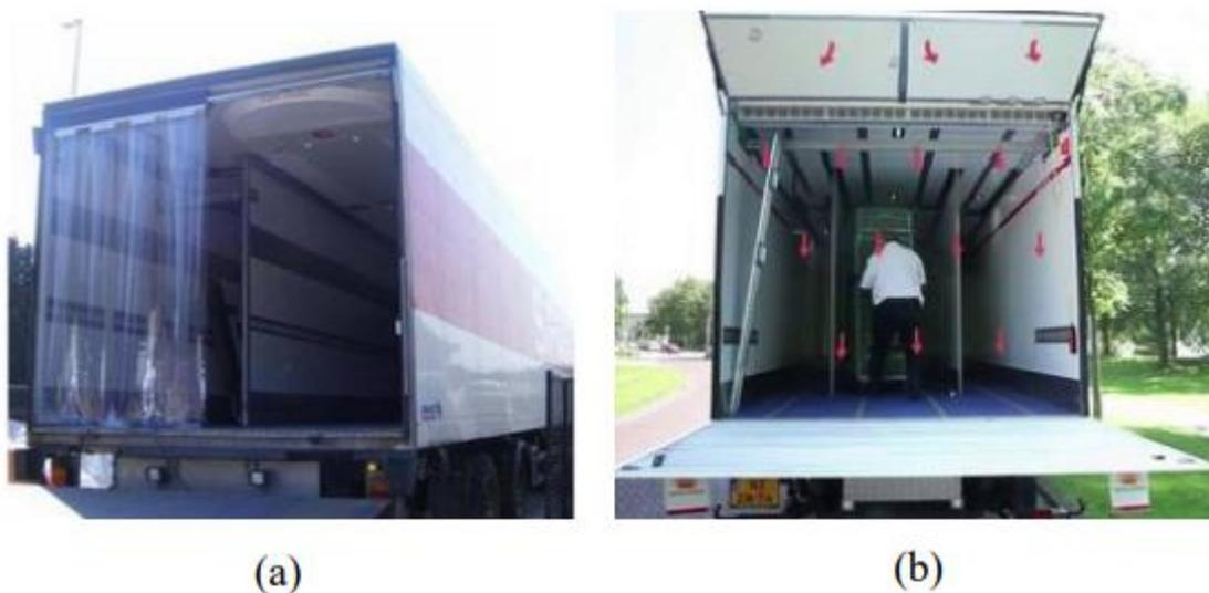
*Figura 16: Meccanismi per diminuire le perdite per infiltrazioni durante il carico e scarico della merce. (a) tenda a strisce in PVC, (b) meccanismo basato su flussi di aria*
