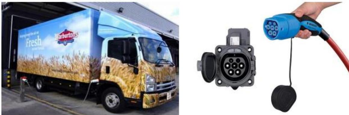
*Figura 26: Esempio di veicolo refrigerato totalmente elettrico con relativo plug di ricarica*
