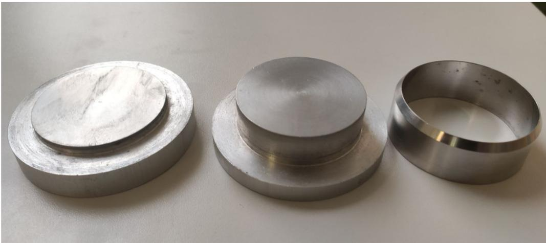
Figura 5.1: Compattatori per i due strati e anello edometrico
