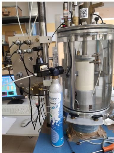
Figura 3.12: Saturazione provino con anidride carbonica
