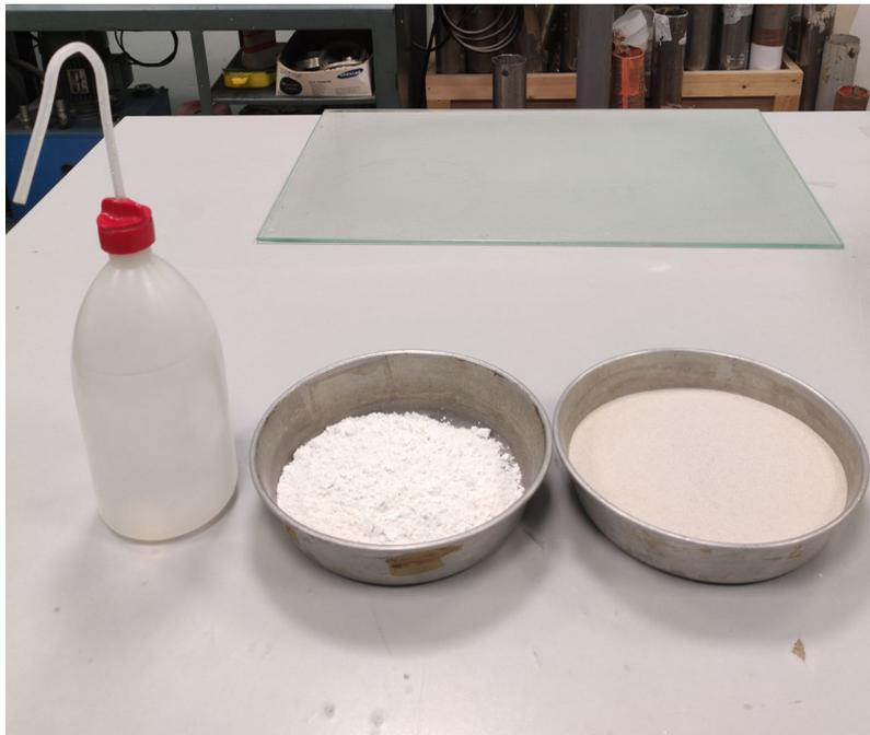
Figura 3.10: Acqua distillata, caolino e sabbia prima della miscelazione
