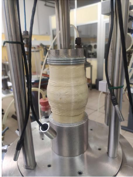
Figura 3.13: Deformazione a botte del provino
