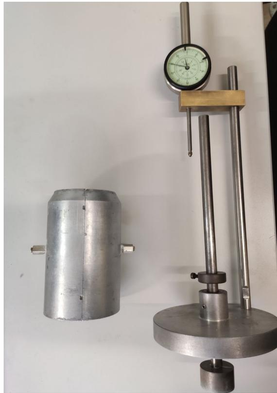
Figura 3.11: Pestello regolabile e mold metallico
