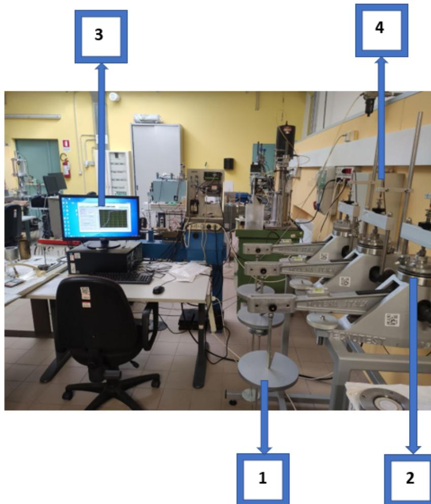
Figura 5.4: Sistema per prove edometriche
