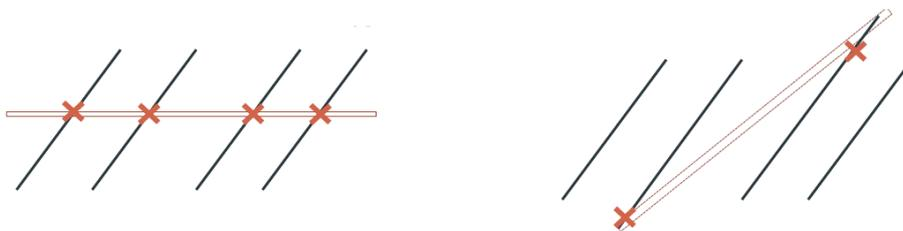
**Figura 1.9:** Errori nei dati di rilievo: errore di Terzaghi
