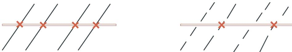
**Figura 1.8:** Errori nei dati di rilievo: differente persistenza delle discontinuità
