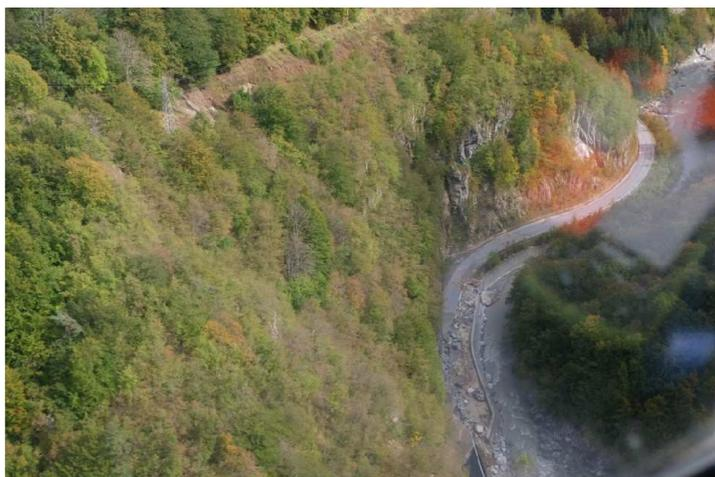
**Figura 2.16:** Fenomeno di erosione di sponda causato dal torrente Negrone (Rapporto evento alluvione 2-3 Ottobre 2020, ARPA Piemonte)
